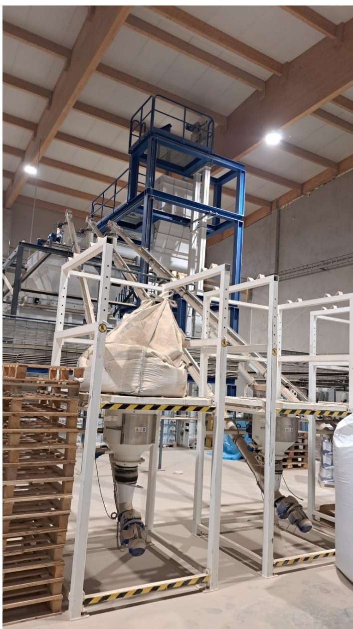
Kuva 1. Fertilexin lannoitetehtaalla lannoitekomponentit sekoitetaan panostoimisessa sekoittajassa ennen pelletointiä.
