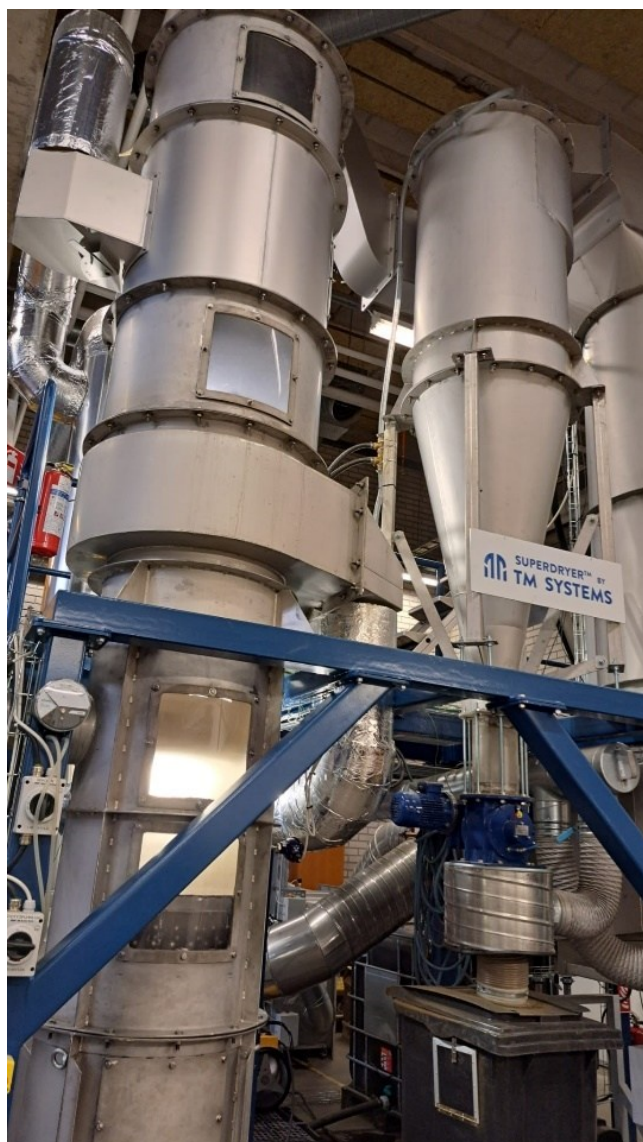
Kuva 4. TM Systems Oy:n Super Dryer -pilot leijupetikuivuri.
