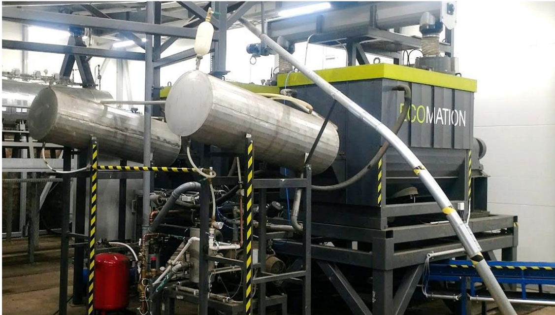
Kuva 5. Ecomation Oy:n suurempi 1 m 3 Pilot-vakuumikuivuri.
