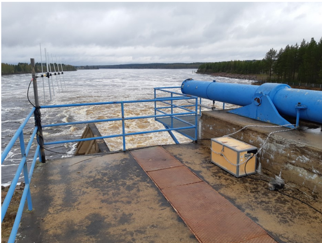
Kuva 3. Radiovastaanotin (laatikossa) ja kuusielementtinen Yagi-antenni asennettuna Valajaskosken ohjuksutuspadolle. Kuva: Panu Orell.
