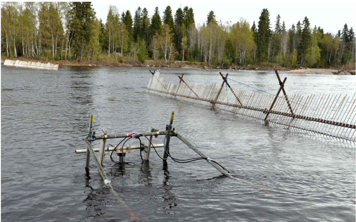
Kuva 3. Luotain suunnataan siten, että kaikki ohjausaitojen välistä uivat kalat on mahdollista havaita.
