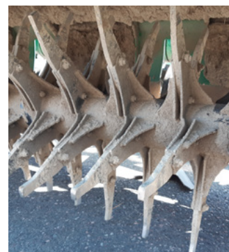
Kuva 4 ja 5. Kwick-Finn -juolannostimen versio savimaille. Normaaliit piikit (vrt. kuva 3) on korvattu kuvassa näkyvällä järeällä roottoriyksiköllä.
