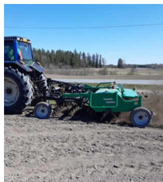
Kuva 4 ja 5. Kwick-Finn -juolannostimen versio savimaille. Normaaliit piikit (vrt. kuva 3) on korvattu kuvassa näkyvällä järeällä roottoriyksiköllä.
