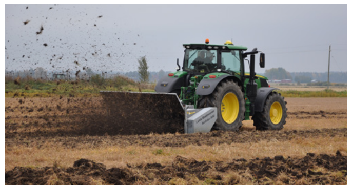
Kuva 7. BioRotor-juolannostimessa roottorin rakenne on tehty niin vahvaksi, ettei esimuokkausta tekevää kultivaattoriosaa tarvita.
