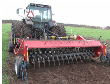
Kuva 3. Kwick-Finn-juolannostin nurmen lopetuksessa. Parin ajokerran jälkeen työäljen pitäisi näyttää tältä. Juolavehnan juurakoita on pinnalla kuivumassa.
