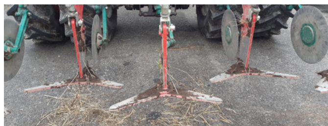
Kuva 6. Kverneland-juuristoleikkurissa on läpileikkaavat terät, joilla voi katkaista kestorikkakasvien juuristoa maata kääntämättä. Muokaussyvyyyttä säädetään rikkakasvilajin ja ajankohdan mukaan.
