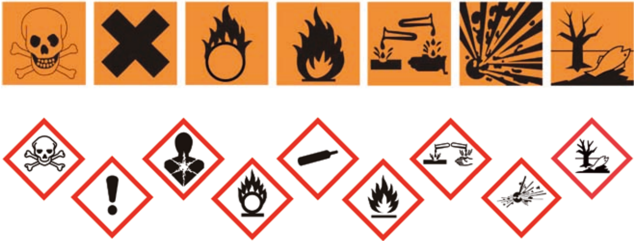
Kuva 1. Yläkuva, vanhat oranssipohjaiset vaamerkinat: 1. Myrkyllinen (T), erittäin myrkyllinen (T+) 2. Haitallinen (Xn), ärsyttävä (Xi) 3. Hapettava (O) 4. Helposti syttyvä (F), erittäin helposti syttyvä (F+) 5. Syövyttävä (C) 6. Räjähävä (E) 7. Ympäristölle vaarallinen (N). Alakuva, uudet GHS:n mukaiset vaamerkinat: 1. Pääkallo - akuutisti myrkylliset aineet 2. Huutomerkki - akuutisti myrkylliset, iho-, silmä- ja hengitystieärsytystä aiheuttavat aineet, ihoherkistäjät 3. Mureneva mies - elinvaurioita aiheuttavat, karsinogeeniset, mutageeniset ja lisääntymismyrkylliset aineet, hengitystieherkistäjät 4. Palava happiatomi - hapettavat aineet 5. Kaasupullo - paineenalaiset tai nesteytetyt kaasut 6. Liekki - helposti syttyvät aineet 7. Koeputket - syövyttävät ja vakavan silmävaurion vaaraa aiheuttavat aineet 8. Räjähähdys - räjähdysvaaraa aiheuttavat aineet 9. Kala selällään - ympäristölle vaaralliset aineet.
