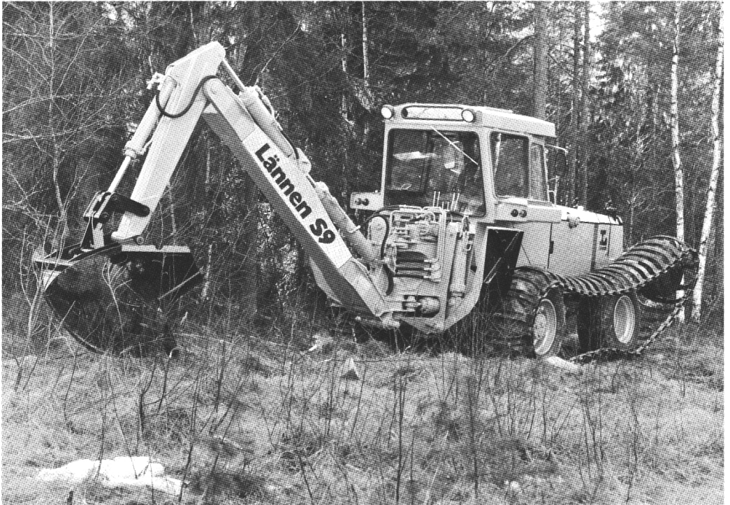
Kuva 3. Lännen S9 metsäojien perkauskone. Figure 3. The Lännen S9 excavator for ditch cleaning work.
