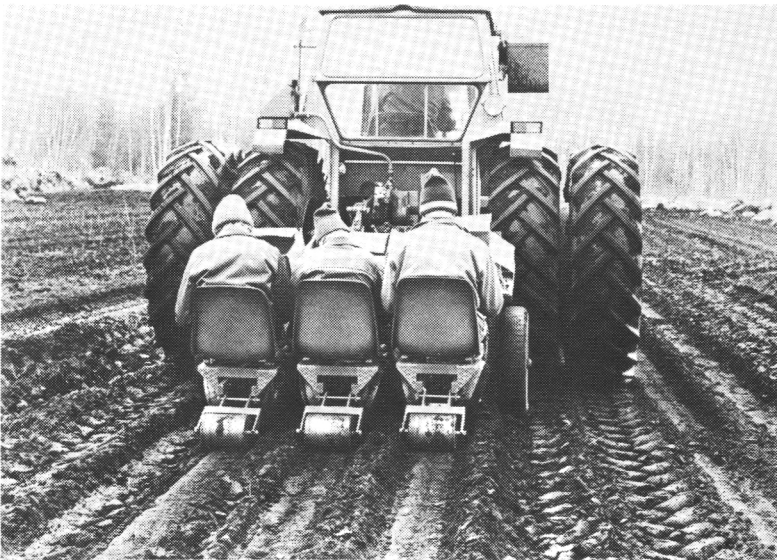
Kuva 4. Koneistutusta vaakaan. Peruskoneena Lännen Tehtaiden valmistama 3-paikkainen koulintakone.
