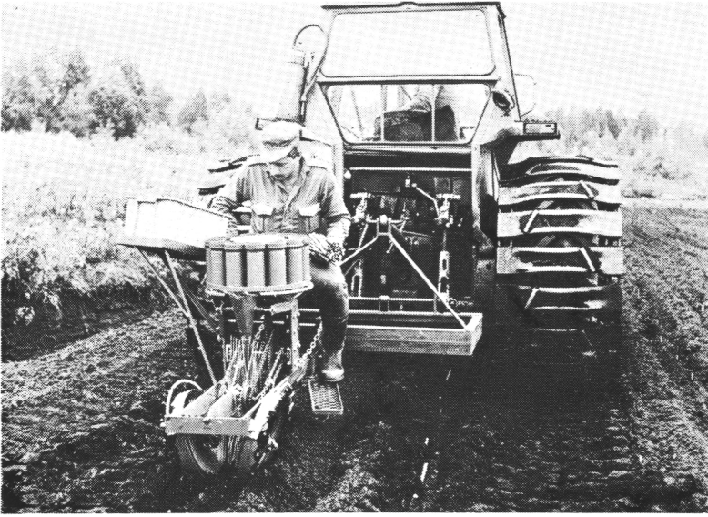
Kuva 3. Koneistutusta pystyyn. Peruskoneena Lännen Tehtaiden valmistama paperpot-istutuskone.
