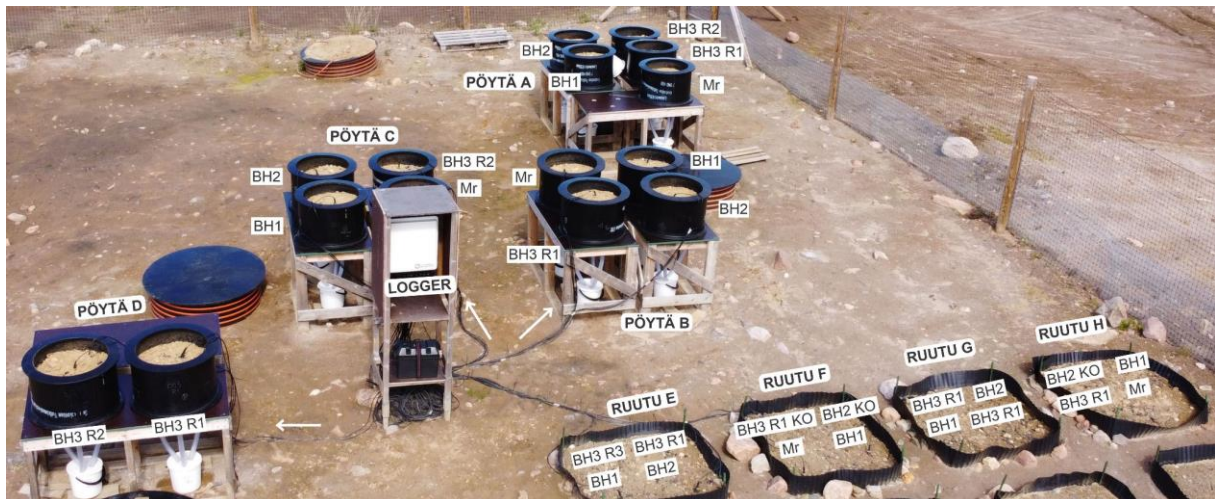
Kuva 7. Kuvan yläreunassa lysimetrikokeet (mustat sylinterit vesienkeruupöydillä, halkaisija 60 cm) ja sensoriaineiston tiedonkeruuasema (Logger). Kuvan alareunassa ruutukokeet, jossa ruutun koko 1 m 2 (Kuva: Pauliina Liwata-Kenttälä & Riitta Turunen/GTK).
