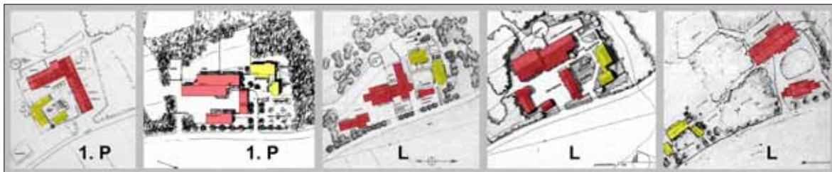
Kuva 9. Vuoden 1986 maatalon talouskeskuksen suunnittelukilpailun palkittujen ehdotusten asemapiirroksia (keltainen = asunto, punainen = tuotantorakennus). Rakennusten sijoittelussa on vielä tavoiteltu perinteistä umpipihaa joko yhden tai kahden pihan periaatteella. Yksi lunastetuista ehdotuksista on sijoittanut tuotantorakennukset selkeästi erilleen varsinaisesta asuinpihasta (kuva Arkkitehti-lehden kilpailuliitteestä 7/1986).
