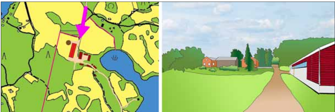
Kuva 76. Uuden pihaton sijoitus tulotien varteen. Maasto laskee pohjoiseen päin ja rakennettavuus vaihtelee. Rakennus pitäisi paaluttaa pohjoispäästä ja samalla syntyisi tarve rakennusalueen täyttölle.
