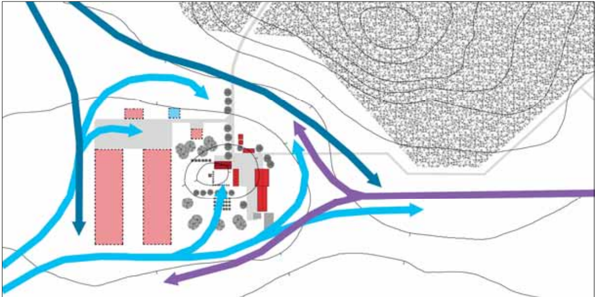
Kuva 26. Uudisrakennusten sijoitus ideaalipihaan länsipuolelle (tässä esimerkissä) vaikuttaa vallitsevien tuulten käyttäytymiseen sekä uudessa että vanhassa pihassa. Lumen kertyminen ja kinos tuminen ja edelleen auraamisen tarve on tiedostettava rakennuspaikan valintaa tehtäessä. Samalla tavoin sijoitusvalinta vaikuttaa karjan jaloittelualueiden lumitilanteeseen, puhtaanapitoon ja sulamisvesien määrään.
