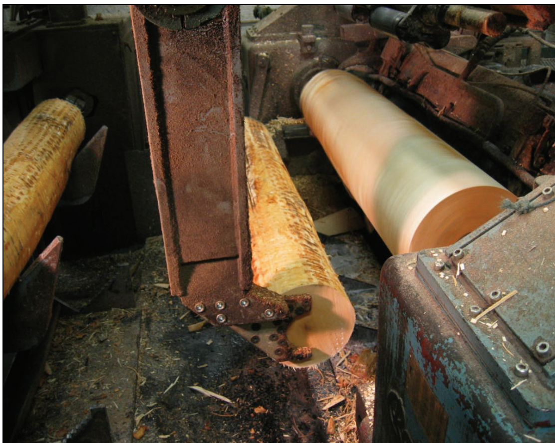
Kuva 4. Latvan tukkierän nro 3 sorvaus UPM-Kymmene Oyj:n Joensuun vaneritehtaalla. Kuva: Vesa Alaha
