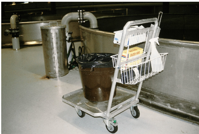
Bild 54. Vagn för uppsamling av död fisk utvecklad vid Lukes fiskodlingsanläggning i Taivalkoski (Foto Matti Karjalainen, Luke).
