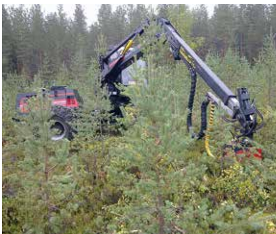
Фото б.4. Уход за молодым сосняком с помощью режущей головки компании MenSe Oy, установленной на харвестере. Фото: Институт природных ресурсов Финляндии / Яри Мийна.
