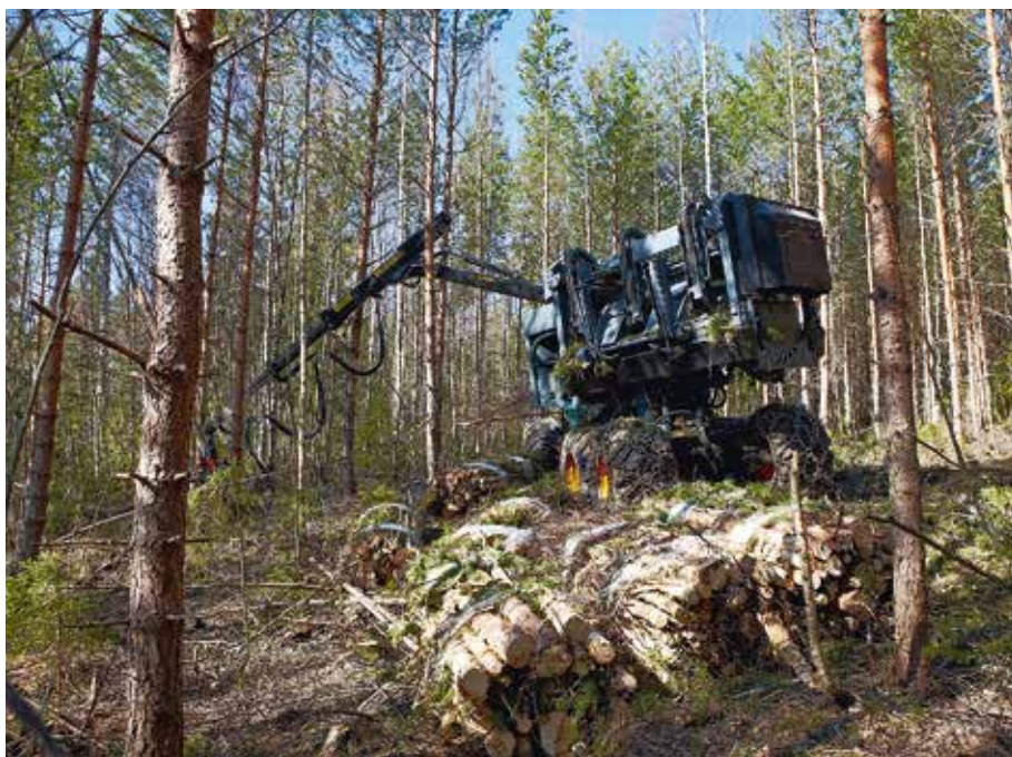
Фото 7.11. Валочно-пакетирующая машина в нерасчищенном молодом древостое выполняет прореживание. Фото: Fixteri Oy.
