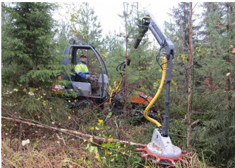
Фото 6.3. Прочистка в хвойном молодняке с помощью кусторезного оборудования «Tehojätkä UW40» компании Usewood Oy. Технологические коридоры в молодняке для этого вида работ не прокладываются. Фото: Институт природных ресурсов Финляндии / Карри Утила.
