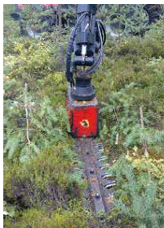
Фото б.4. Уход за молодым сосняком с помощью режущей головки компании MenSe Oy, установленной на харвестере. Фото: Институт природных ресурсов Финляндии / Яри Мийна.
