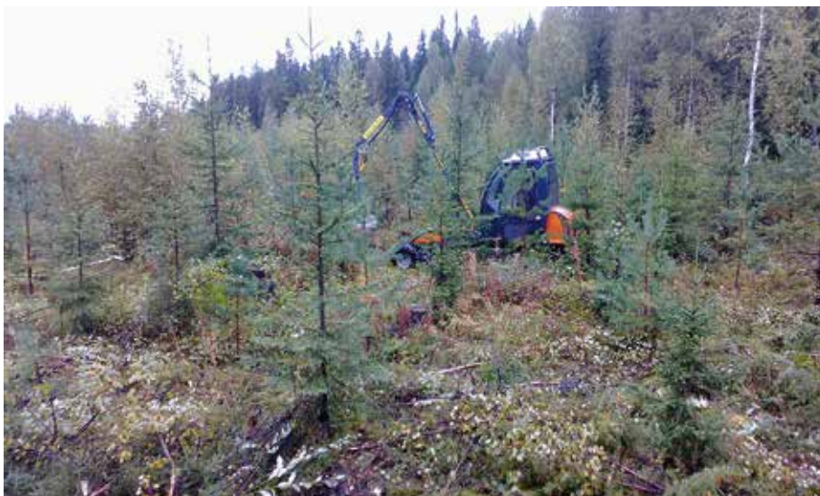
Фото 8.6. Малогабаритный лесной трактор «Usewood Tehojätkä» осуществляет срезание деревьев с помощью кусторезного устройства. Достойная альтернатива ручному труду при условии, если на объекте прочистки удаляемый древостой уже стал более крупным и имеет высокую густоту. Фото: Институт природных ресурсов Финляндии / Карри Уотила.
