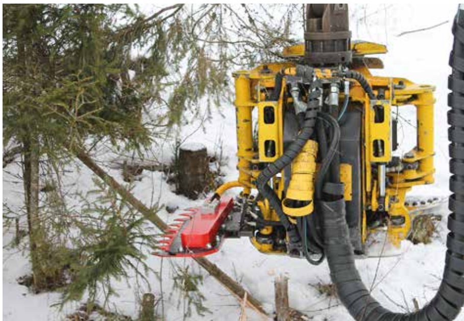
Фото 7.10. Расчистка с помощью кусторезной установки на харвестерной головке повышает эффективность первого прореживания. Фото: MenSe Oy / Марья-Леена Ментула.
