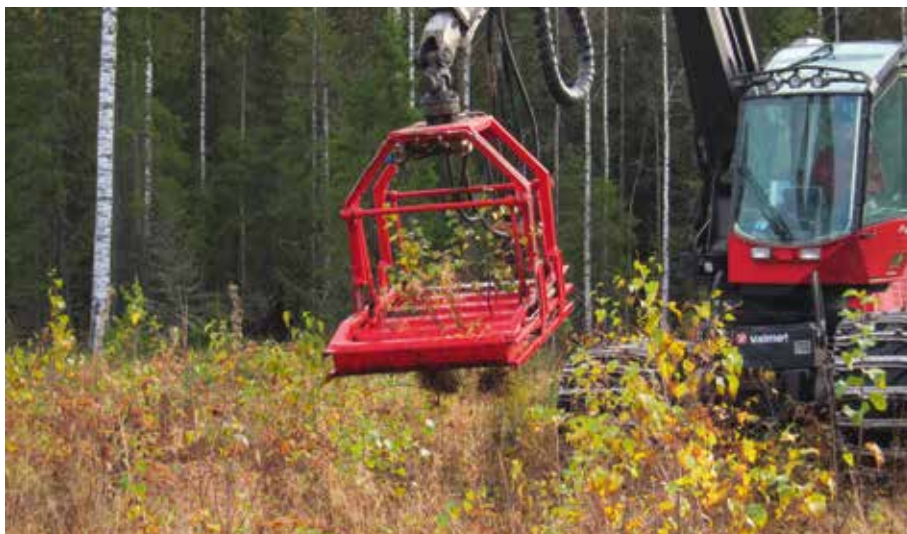
Фото 5.8. Машинизированное осветление в культурах ели выполняется агрегированным с харвестером осветлителем «Naarva P25». Уход на объектах, покрытых обильной порослью, проводят весной или осенью. Фото: Институт природных ресурсов Финляндии / Карри Уотила.
