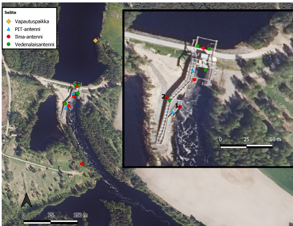
Kuva 7. Tutkimusalue Leuhunkosken voimalaitospadolla ja alueelle asennettujen seuranta-antennien sijoittuminen ja kalojen vapautuspaikka. Kalatien alapäähän sijoitettu antenni jouduttiin häiriöiden takia siirtämään ylemmäs (numerot 1 ja 2). Sisältää Maanmittauslaitoksen (10/2021) aineistoa.
