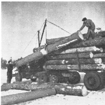
Koneellisten laitteiden avulla saadaan kuormausaika parhaiten tehostetuksi. Työteho-seuran puominosturi. (Työteho-seura).
