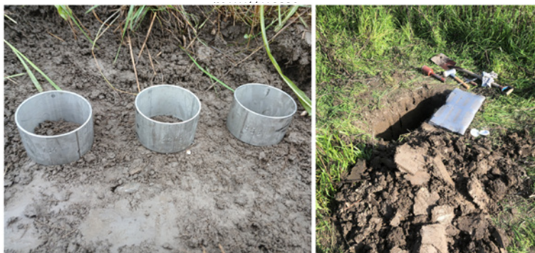
Kuva 1. Maaperänäytteiden ottoa vedenpidätyskyvyn laboratoriomäärittelyä varten syvyyksiltä 0–60 cm. Näytteet otetaan metallilieriöihin lyömällä ne maahan.
