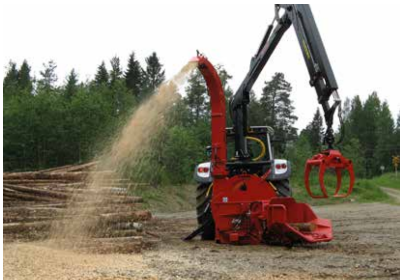
Рис. 8. Дисковая мобильная рубильная машина на базе трактора. Изготовитель: Farmi Forest. (Фото: Farmi Forest Oy)
