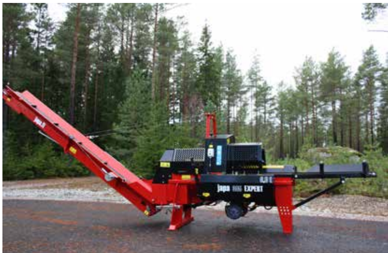
Рис. 7. Дровокол для производства дров из бревен диаметром макс. 38 см. (Фото: Laitilan Rautarakenne Oy)
