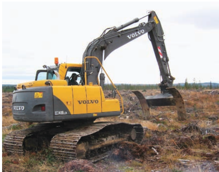
Kuva 1. Kuusamon Maakaivin Ky kehitti laikkumätästyksessä käytetyn kaivinkoneeseen kiinnitetyn muokkauslaitteen Itä-Suomessa aikaisemmin saatujen käyttäjäkokemusten pohjalta. (valokuva Eeva Pudas).
