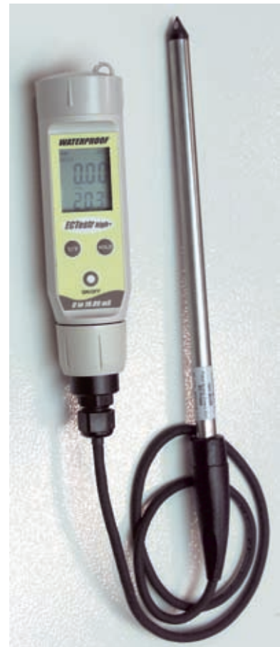
Kuva 1. Field Scout -sähkönjohtavuusmittari, jolla voi mitata kasvualustan johtokyvyn suoraan yksittäisestä paakusta.
