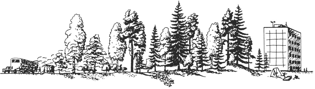
Kuva 4. Poikkileikkaus liikenne-epäpuhtauksia tehokkaasti sedimentoivasta suojavyöhykkeestä.
