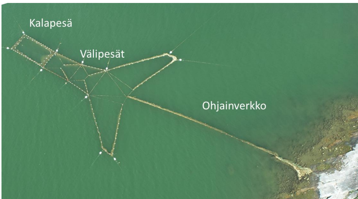
Kuva 7.1. Rysän perusrakenne. Kuvassa avorysä. Kuva: Sanna Kuningas
