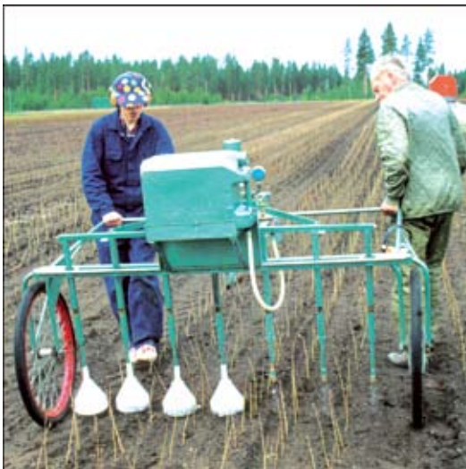
Rikkakasvien torjuntaa riviväliruiskulla. Tutkija Pentti Nisulan kehittämää laitetta testaamassa tutkija Ukko Rummukainen (oik.) ja tutkimusmestari Pekka Voipio. (kuva Markku Tynnyrin)
