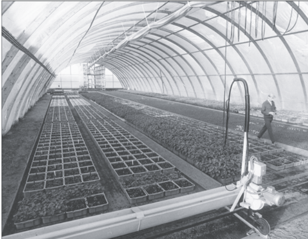
Suonenjoen metsänviljelyn koeasemalla kehitetty Esteri-kastelulaite toimi muovihuoneissa. (kuva Metsäntutkimuslaitos)
