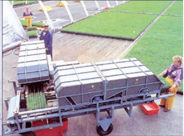
Vapo-paakkumenetelmässä taimet kasvatettiin yhtenäisessä turvelevyssä. Juuripaakut pidettiin erillään leikkamalla turvelevyä kasvukauden aikana. Kuvassa juurten koneellista leikkuuta. (kuva Leo Tervo)
