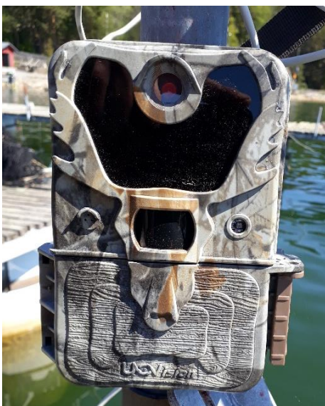
Kuva 2. Uovision-riistakameroiden käyttömahdollisuutta merimetson ja harmaahaikaran seurantaan kokeiltiin kalankasvatusraameilla Saaristomerellä. Kuva: Jari Niukko.
