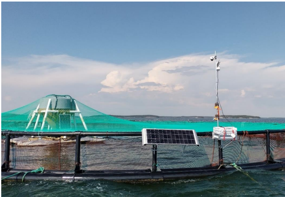
Kuva 12. Valvontakamerajärjestelmä kiinnitettynä raamiin. Kuva: Veera Hauhia.
