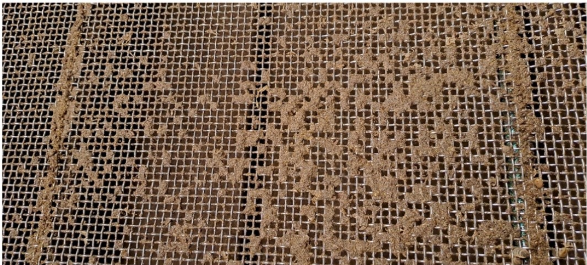
Kuva 18. Liian kostea frassi jää seulaverkkoon kiinni. (Kuva: Henna Pitkänen)
