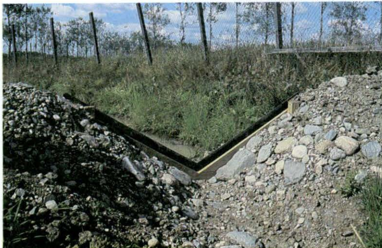
Kuva 10. Maapato, jossa V-aukko virtaamamittausta varten.
