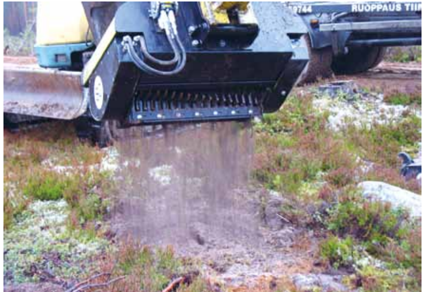
Kuva 1. Männyn kylvöksen peittämistä seulakauhavalmistajan mallistossa valmiina olevalla kauhalla Ähtärissä marraskuussa 2015. (valokuva Pekka Helenius)
