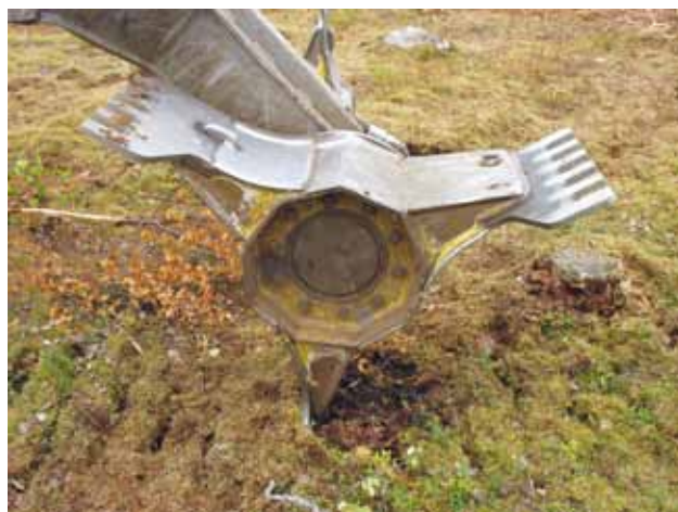
Kuva 3. Uudet kylvömuokkausterät jatkuvatoimisessa mätästäjässä. (valokuva Pekka Helenius)
