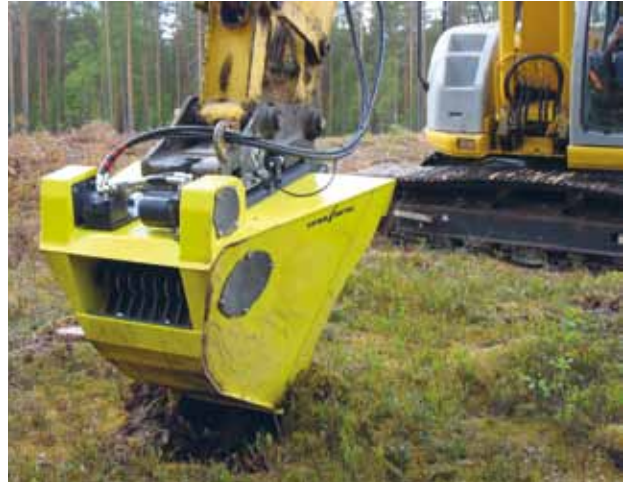
Kuva 2. Vipermetal/Ajutech Oy:n valmistamalla seula- tai monitoimikauhalla voi laikuttaa, kylvää, peittää siemenet, mätästää ja kaivaa ojaa. Kylvölaite on tässä vielä suojaamattomana, ohjaamosta katsottuna kauhan oikeassa reunassa. (valokuva Pekka Helenius)
