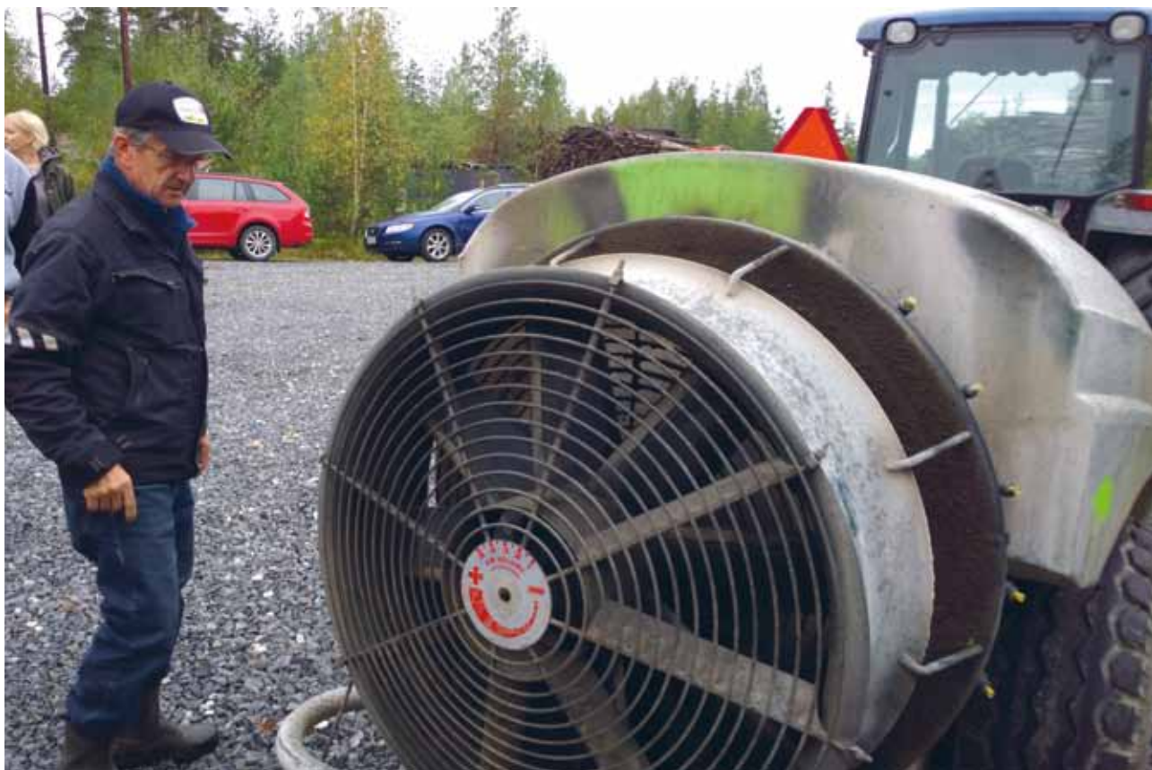
Kuva 4. Jorma Jaakkola esittelee käyttämäänsä sumuruiskua, jonka ilmanottoa säädetään lapojen kulmaa säätämällä. Jaakkola käyttää ruiskussaan ilma-avusteisia suuttimia, jotka vähentävät veden kulutuksen puoleen normaalista. Keltaiset suuttimet näkyvät ilmanottolaitteen ulkokehällä. (valokuva Tiina Ylioja)
