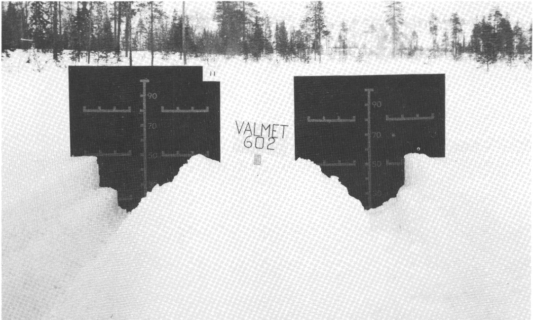
Kuva 14. Raiteiden kuvauksessa käytetyt taustalevyt. Fig. 14. Scale plates used in photographing the ruts.
