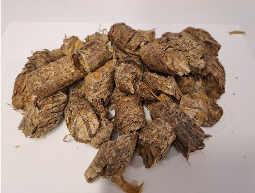
Kuva 2. Kronen Premos-laitteistolla valmistettu olkipelletti.
