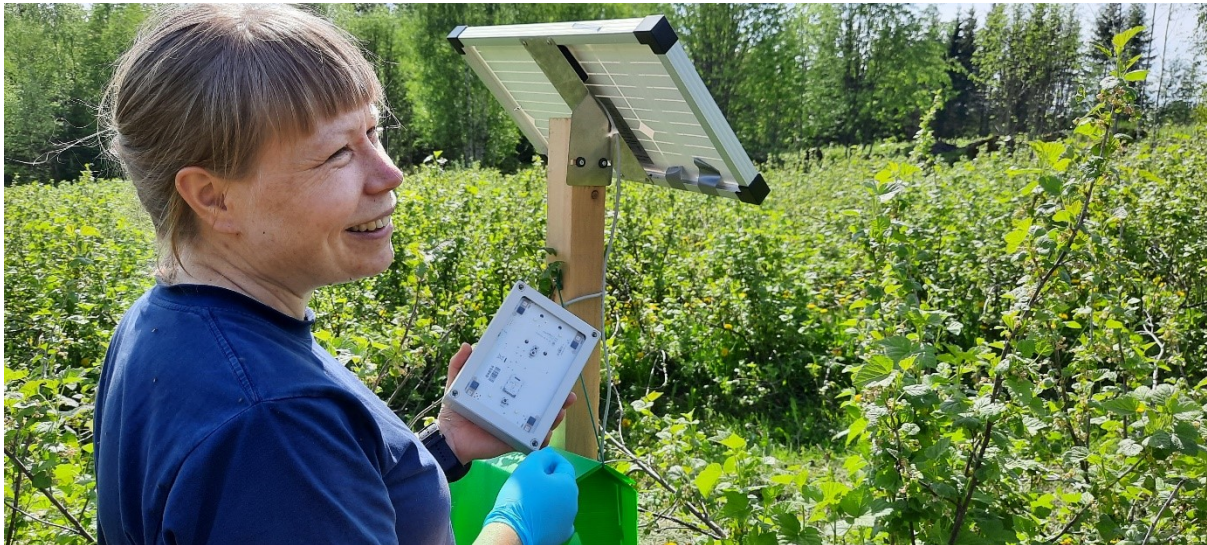
Kuva 34. Etäluettavan ansan ohjausyksikössä on kaikki tarvittava: akku, gps-paikannus ja kamerat liimapaperin kuvaamiseen. Kuva: Saara Tuohimetsä, Luke.
