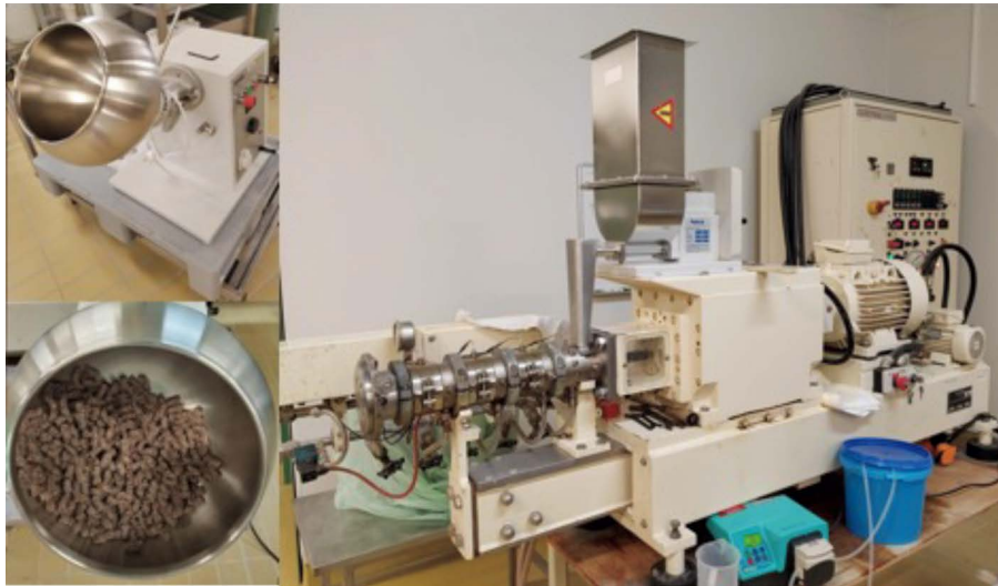
図1. エルヴェカ社のAR 403コーティングドラムと クレクストラル社のBP10二軸押出機。
