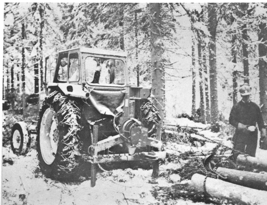
Kuva 1. Tutkimuksessa käytetty laitteisto sekä tukkitaakan kiinnitys juontosaksilla ja ketjuilla.
