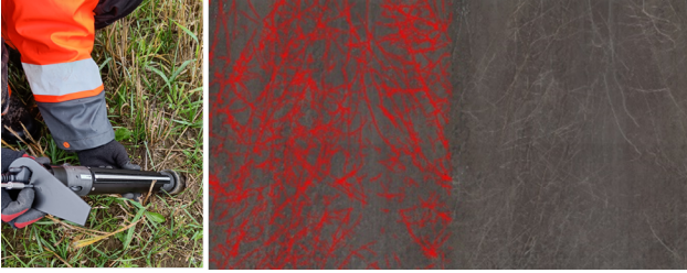
Kuva 1. Juuristokuvausta voidaan tehdä siihen tarkoitettun kameran avulla. Kuvat käsitellään automaattisella tunnistuksella, joka tunnistaa juuret kuvasta paljon ihmissilmää tarkemmin. Kuva: Panu Korhonen/Luke
