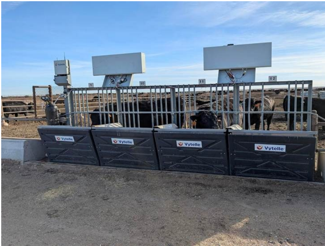
Kuva 17. Vytelle Sense Methane™ -mittaussjärjestelmä kuvattuna feedlot-kasvattamossa. Järjestelmä toimii yhdessä Vytellen rehunkulutuksen mittaussjärjestelmän kanssa. Kuva: Vytelle.
