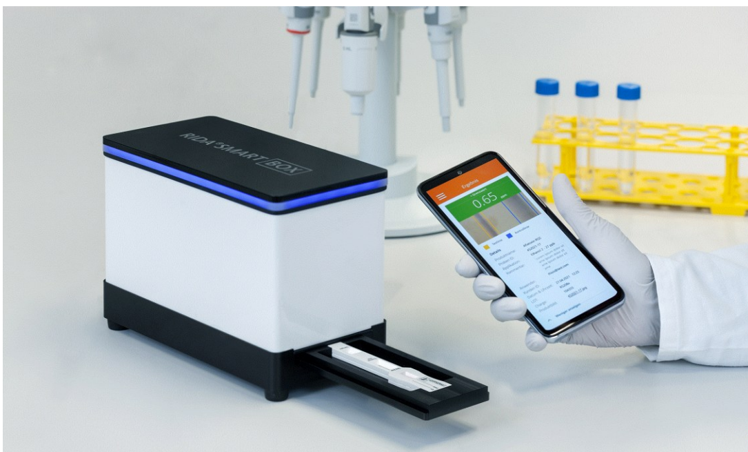
Kuva 13. RIDA Smartbox on nopea ja helppokäyttöinen mykotoksiinien analyysilaitte. Kuva: Mediq.
