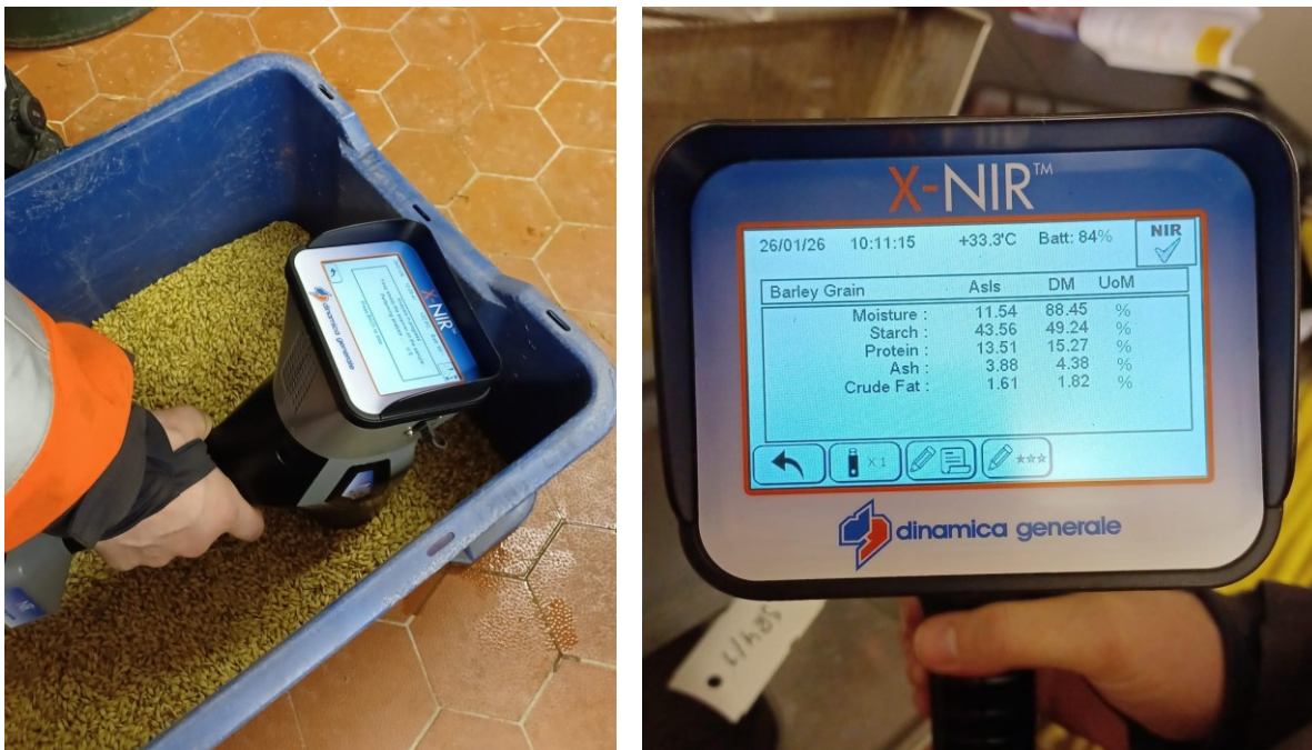
Kuva 14. Rehuohran analysointia käsikäyttöisellä X-NIR-laitteella. Kuvat: Outi Ukkola/Luke.
