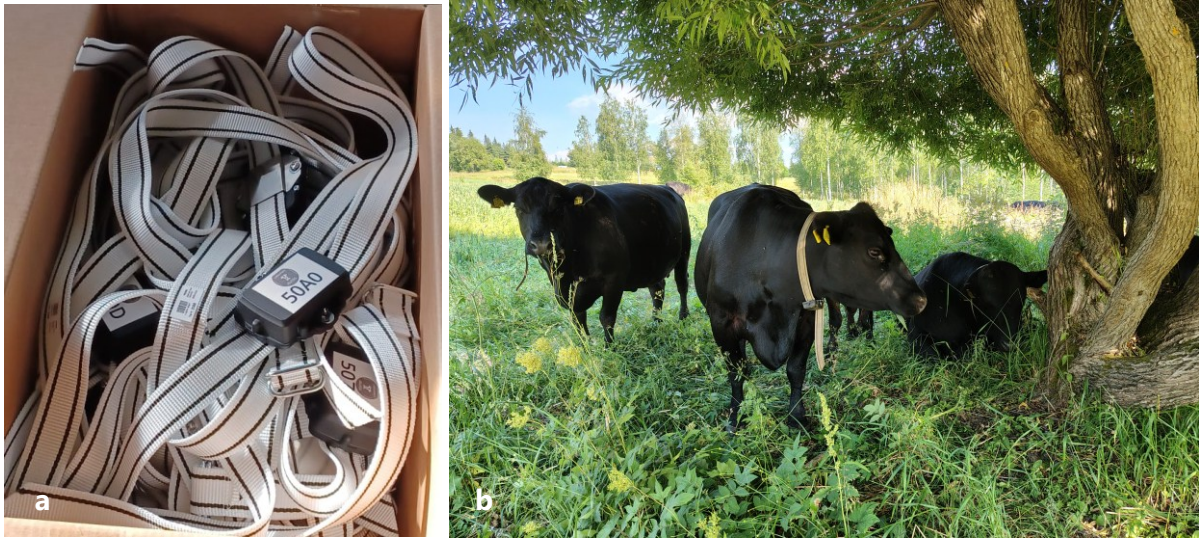
Kuva 12. a) Laidunna.fi paikannusjärjestelmän GPS-paikannuslaitteet kaulapanttoineen. b) Paikannuslaitteet kiinnitettyinä eläimiin. Kuvat: Outi Ukkola ja Leena Tuomisto/Luke.
