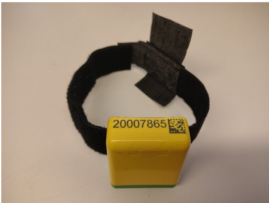
Kuva 25. IDS i-QUBE-kiihtyvyyssanturi kiinnitetään tarranauhalla eläimen jalkaan. Kuva: Leena Tuomisto/Luke.
