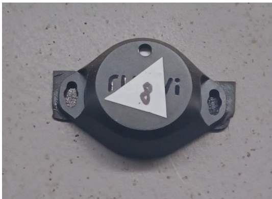
Kuva 7. RuuvTag Pro 4-in-1-anturit mittaavat jatkuvasti lämpötilaa, ilmankosteutta ja ilmanpainetta. Kuva: Leena Tuomisto/Luke.
