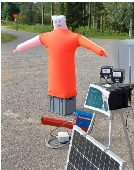
Kuva 4. BirdAlert-lintujen karkotuslaitteistoon kuuluvat mikrofoni ja kaiuttimet, jotka toimivat verkkovirralla tai aurinkopaneelilla, sekä lisälaitteet pelotinhahmo ja kaasutykki. Kuva: Leena Tuomisto/Luke.
