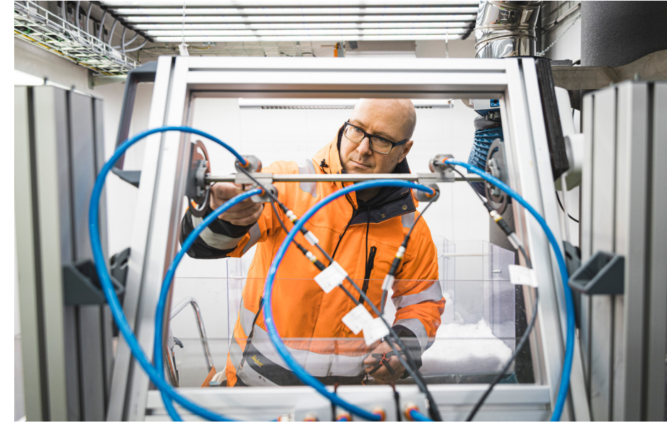
Kuva 105. Maaningalla sijaitsevalla SIMU-pintavaluntasimulaattorilla tehdään ravinnehuuhtoumatutkimusta. Tutkimusinsinööri Ilpo Nuutinen säätää suuttimia. Kuva: Akseli Muraja.
