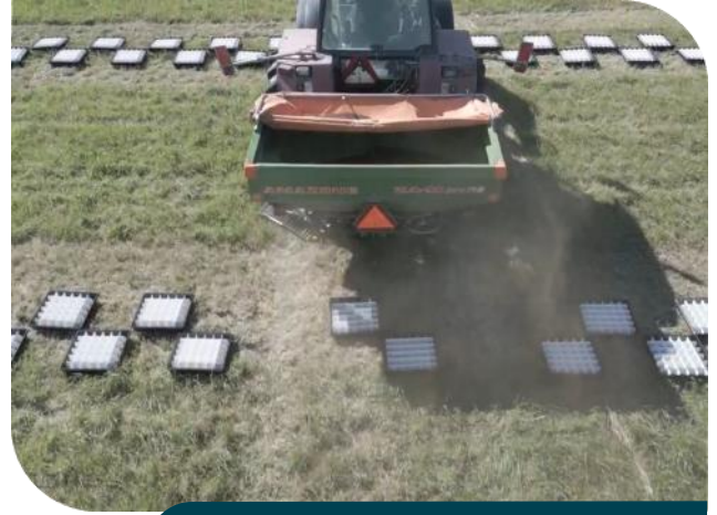
Kuva 1. Levityskuvion mittaus Amazone ZA-M Profis 1500 -keskipakoislevittimellä.
