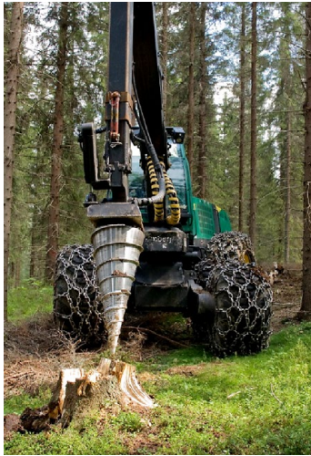
Kuva 6.8. Kantokaira työssä ja kannon halkaisijan vaikutus kannonnoston osa-aikoihin. Valokuva Metla/Tommi Räsänen.
