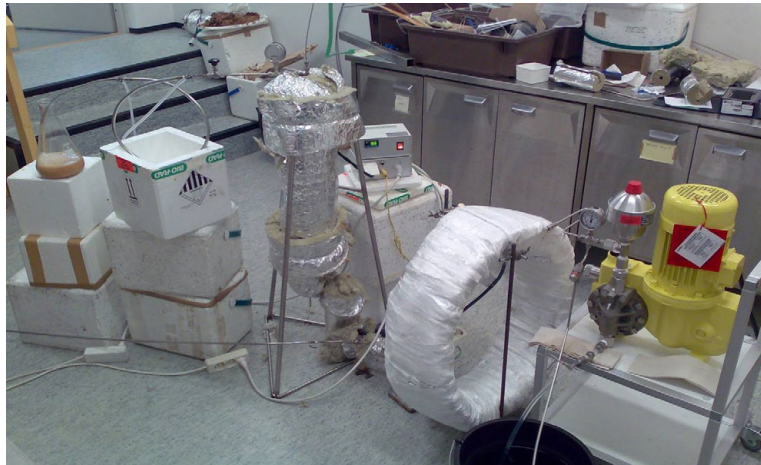
Kuva 23.3b. Kokeissa käytetty 3 litran uuttolaitteisto. Oikealta vasemmalle: Liuosten kuljettamiseen käytettävä, kemikaaleja kestävä pumppu, jonka virtausnopeutta voidaan säätää, lämmityskierukka, lämmitettävä 3 litran uuttoastia ja lämmönsäätöyksikkö (uuttoastian takana). Lasisessa keräysastiassa vaaleanruskeaa kuumavesiuutetta. Kuva Metla/Petri Kilpeläinen.
