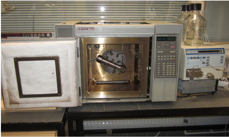
Kuva 23.3a. Kokeissa käytetty 50 ml:n uuttokammio on sijoitettu kaasukromatografian uuniin, jonka avulla uuttolämpötilaa voidaan säädellä tarkasti. Uuttoliuoksen pumppaus tapahtuu kuvassa oikealla olevalla pumpulla. Kuva Metla/Kaisu Leppänen.
