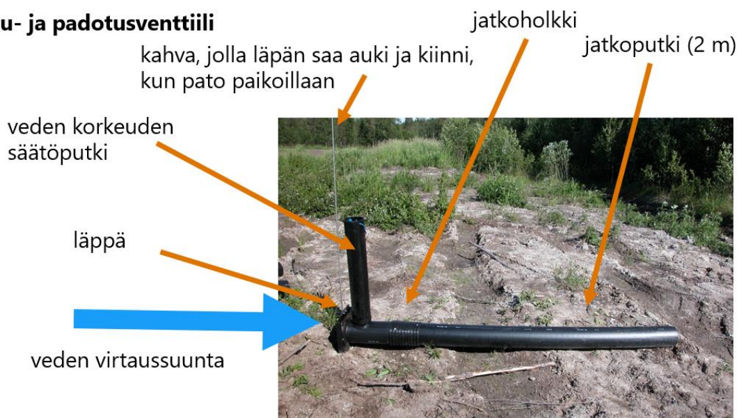
Kuva 28. Sarkaojien päihin asetettiin sulku- ja padotusventtiilit, joiden avulla vedenpintaa saatiin nostettua säätöputken mukaiselle korkeudelle. Tarvittaessa putken päästä sai avattua luukun, jolloin veden laskeminen nopeasti onnistui.
