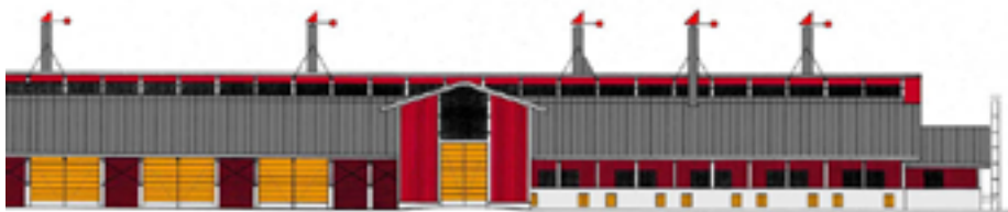
Kuva 59. Esimerkki painovoimaisella ilmanvaihdolla varustetun luomusikalan etujulkisivusta. Runkorakenteena on kuvan 55 mukainen ratkaisu.
