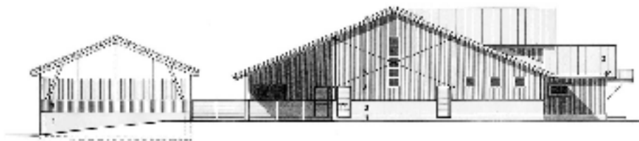
Kuva 58. Esimerkki kuvassa 57 esitetyn luomusikalan päätyjulkisivusta. Lantala on katettu.
