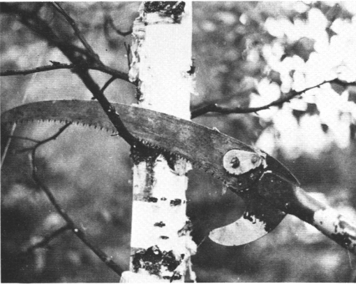
Kuva 12. Oksasaha on perinteinen suomalainen karsimisväline, joka soveltuu etenkin pienialaisiin karsimistehtäviin. Valok. Yrjö Vuokila.
