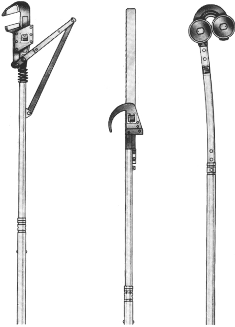
Kuva 13. Fiskarsin HP-karsimisvälineet vasemmalta oikealle: oksaleikkuri, itsesyöttävä oksasaha ja pyörökatkoja.
