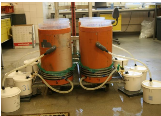
Kuva 3. Sadetuskokeessa maamonoliittejä sadetettiin kahtena peräkkäisenä päivänä. Mono-liitin läpi valuvasta vedestä otettiin näytteitä, joista analysoitiin ravinne- ja hiilipitoisuudet, pH ja sähkönjohtavuus. Kuvat: Johanna Nikama ja Helena Merkkiniemi, Luke.
