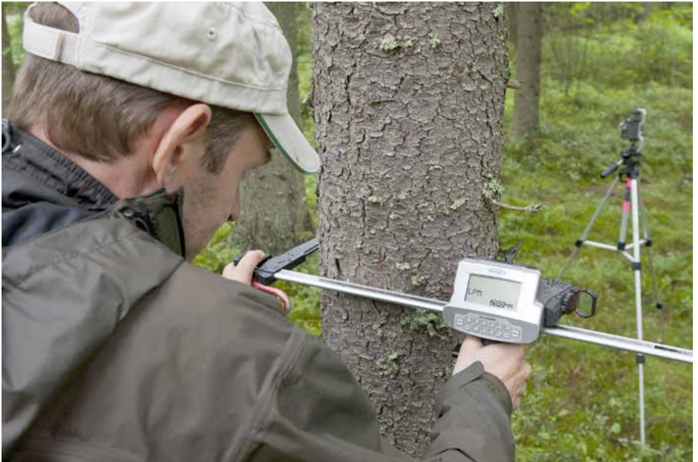
Kuva 5. Puun rinnankorkeusläpimitan mittaaminen elektronisilla mittasaksilla. Kuva: Erkki Oksanen, Luke.
