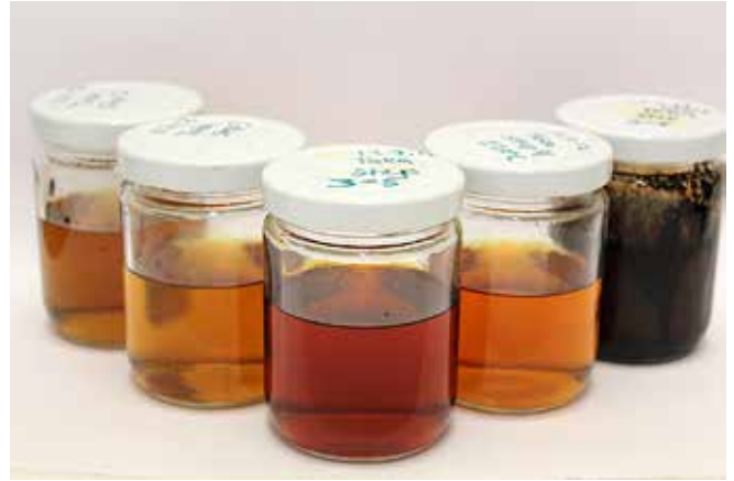
Kuva 2. Hitaassa pyrolyysissä lopputuotteita voidaan helposti muunnella prosessia ohjaamalla. Kuva: Lauri Sikanen.
