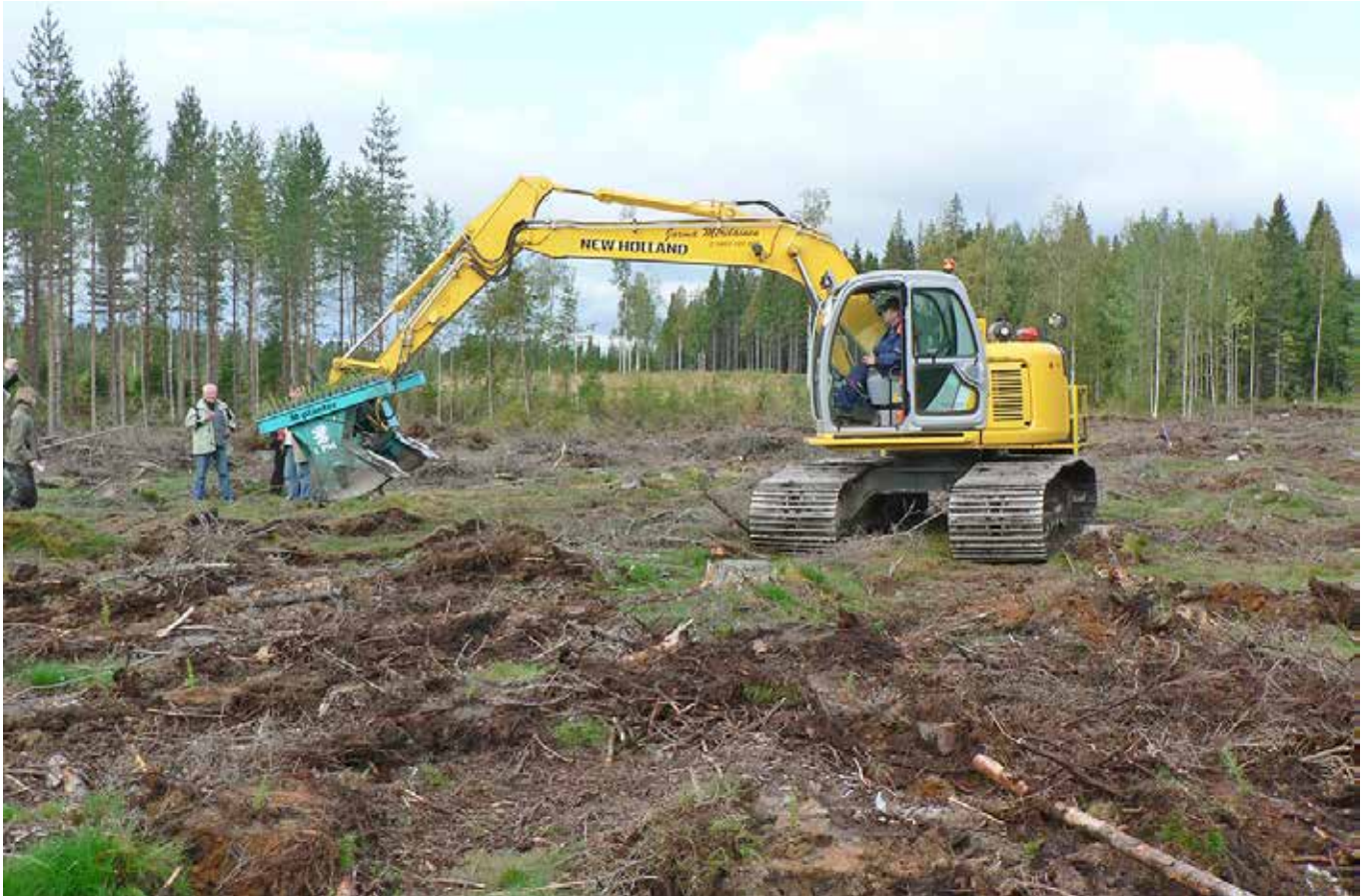
Kuva 2. Metsänhoitotöistä tehdään tulevaisuudessa yhä suurempi osa koneellisesti. Kuvassa M-planter-istutuskone, jolla voidaan tehdä kaksi muokkausjälkeä ja istuttaa molemmat mättäät samalla kertaa. Kuva: Timo Saksa.
