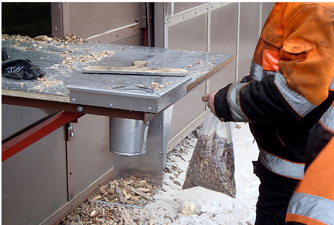
Kuva 8. Kuljettaja ottaa lämpölaitokselle toimittamastaan hakekuormasta kosteusnäytteen. Toimituserästä otettu kokoomanäyte jaetaan lastan avulla osiin sopivankokoisen ja kattavan kosteusnäytteen muodostamiseksi (Kuva Tanja Ikonen, Metsäntutkimuslaitos. 2013).
