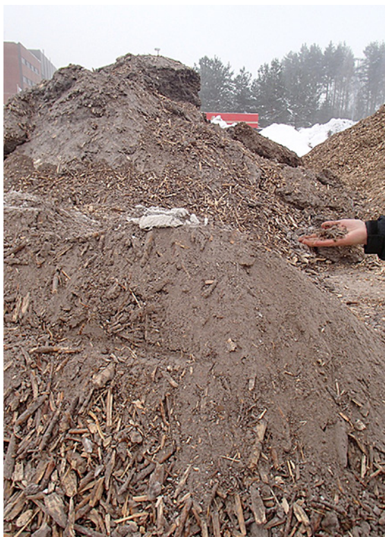
Kuva 13. Laitoksen pihaan kuljetettu hakekasa, joka sisältää enemmän likaantunutta lunta ja maa-ainesta kuin haketta (Tanja Ikonen, Metsäntutkimuslaitos 2013).
