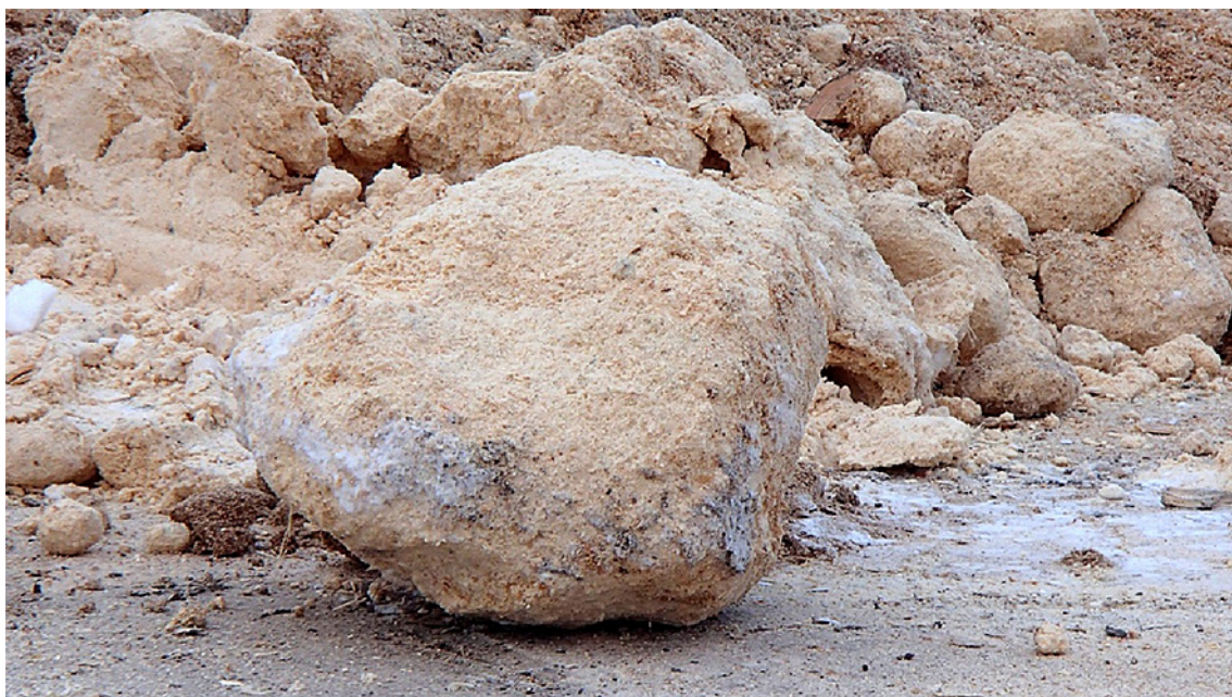
Kuva 14. Suuret jääpalat rikkovat kuljettimia ja laitosten rakenteita (Miina Jahkonen, Metsäntutkimuslaitos, 2013).
