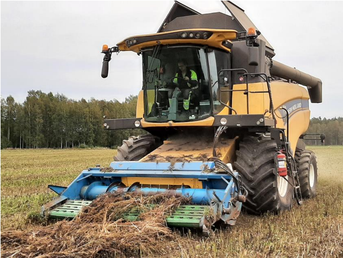
Kuva 14. Luken kokeessa ei käytetty tällaista noukkivaa pöytää, mutta monet kaksivaihekorjuuta soveltavat tilat käyttävät tätä erikoispöytää niitettyjen karhojen puintiin. Kuva: Matts Nysand, Luke.
