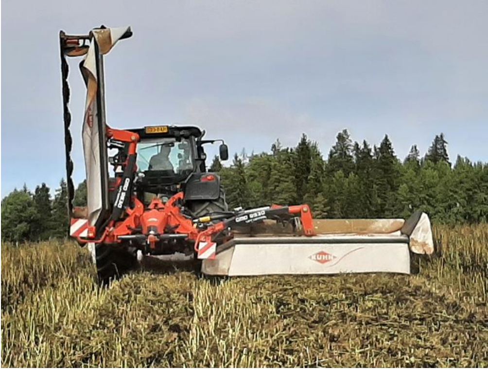
Kuva 12. Härkäpavun niitto käyttäen traktorin etu- ja takakiinnitteisiä lautasniittokoneita, joita verrattiin ajoniittokoneeseen Luken niittomenetelmävertailussa Jokioisilla 31.8.2022. Normaalisti niitettäisiin molempia takaniittoyksiköitä käyttäen, mutta kuvassa käytettiin poikkeuksellisesti vain oikeanpuoleista takayksikköä. Traktorin edessä olevaa etuniittokonetta ei näy kuvasta. Kuva: Matts Nysand, Luke.
