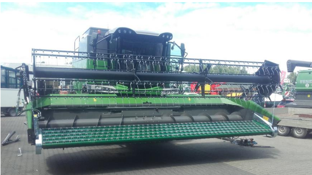
Kuva 15. Vaihtoehtona edellisen kuvan noukkivalle pöydälle on tavallisen leikkuupöydän eteen asennettava pelkkä noukinmatto. Kuva: A. den Dekker & ZN. B.V., https://twitter.com/AdenDekker/status/881891742416601095 .
