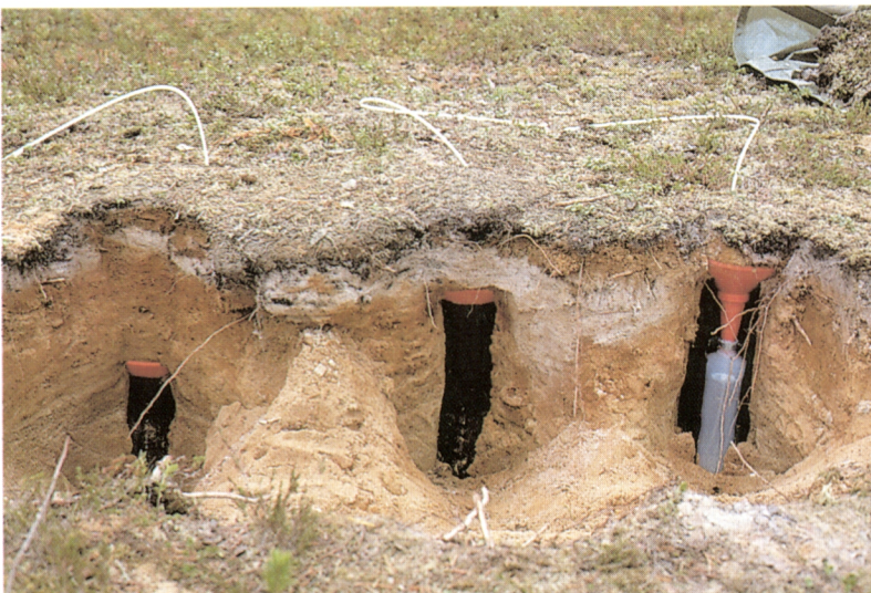
Vajoveden näytteenottoon käytetyt lysimetrit 5, 20 ja 40 cm:n syvyydessä.
