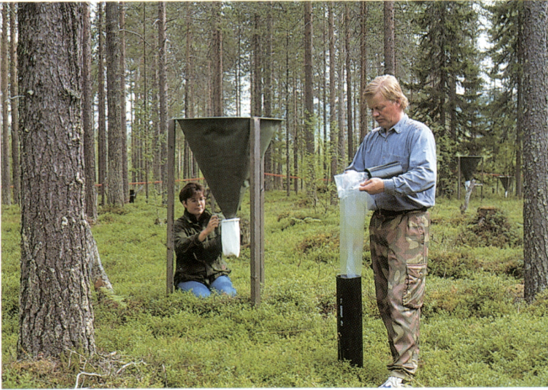
Metsikkösadannan ja karikesadon mittaus näytealalla. Измерение подкороновых осадков и лесного опада на пробной площади.
