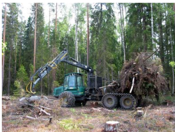
Рис. 23. Трелевка порубочных остатков на сплошной вырубке (Juha Laitila)
