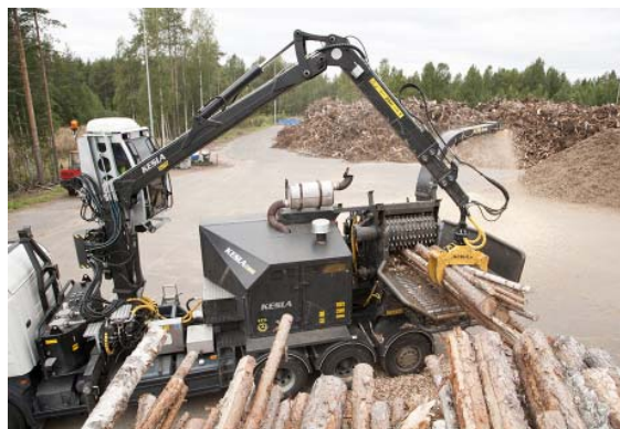
Рис. 15. Тяжелая моторизованная рубильная машина, производя щепу из крупномерной круглой древесины на терминале (Kesla)
