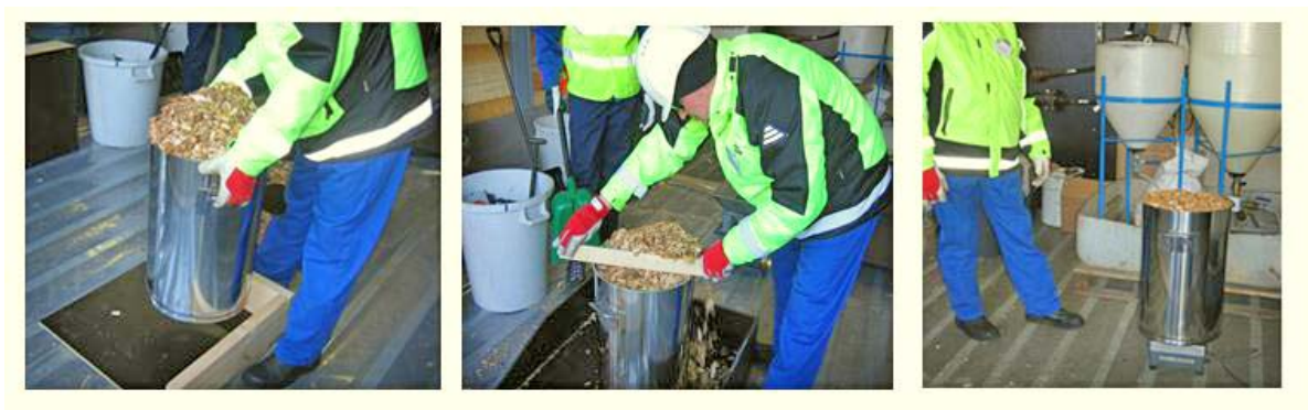
Рис. 46. Наполните емкость (0.05 м³, 50 литров) и сбросьте ее с высоты 15 см на деревянную доску. Повторите это дважды (фото слева), а затем удалите лишний материал небольшой планкой (фото посередине). Взвесьте емкость (фото справа). Вес образца – это общий вес минус вес емкости (взвесить заранее) (SolidStandards)
