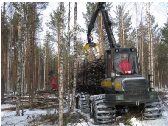
Рис. 19. Традиционная механизированная система заготовки тонкомерной древесины комплексами при рубках ухода (Juha Laitila)
