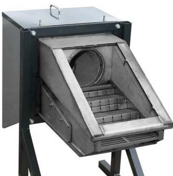
Рис. 44. Система подвижной решетки, предназначенной для 40–1500 кВт. Горелка с подвижной решеткой предназначена для нескольких типов твердого биотоплива. Возможно использование древесины щепы разного качества, древесные или торфяные гранулы, торф и биомассу от сельского хозяйства. Решетка горелки абсолютно мобильна, что дает возможность эффективно смешивать топливо на ее поверхности. Мобильность решетки улучшает перемещение золы в специальное отделение (Ariterm Group)
