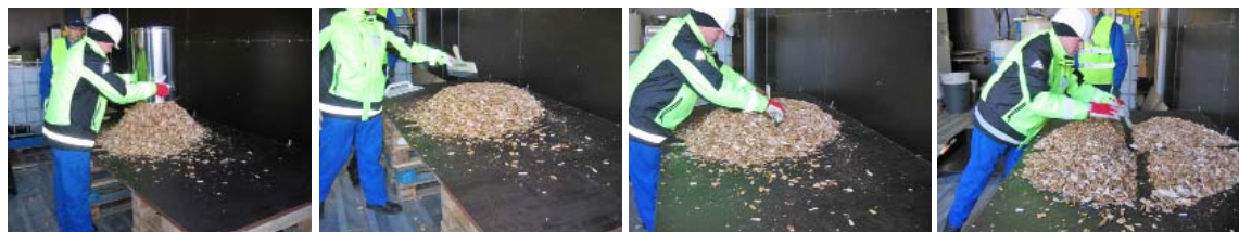
Рис. 47. Формирование конусов и квадратов для анализа содержания влаги. Делить образец столько раз, сколько требуется для получения пробы для анализа содержания влаги (минимум 300 г) (SolidStandards)
