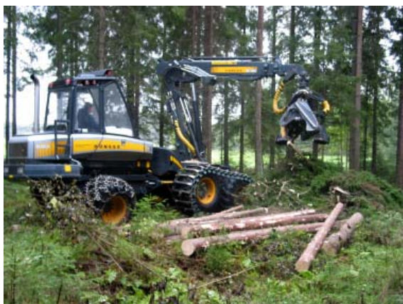
Рис. 17. Интегрированная заготовка промышленного круглого леса и порубочных остатков одно-модульным харвестером (Juha Laitila)
