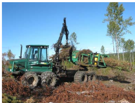
Рис. 24. Пакетирующая машина для порубочных остатков на базе форвардера, сплошная вырубка (Juha Laitila)
