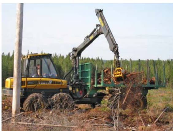
Рис. 25. Трелевка пней и корней на сплошных вырубках (Juha Laitila)
