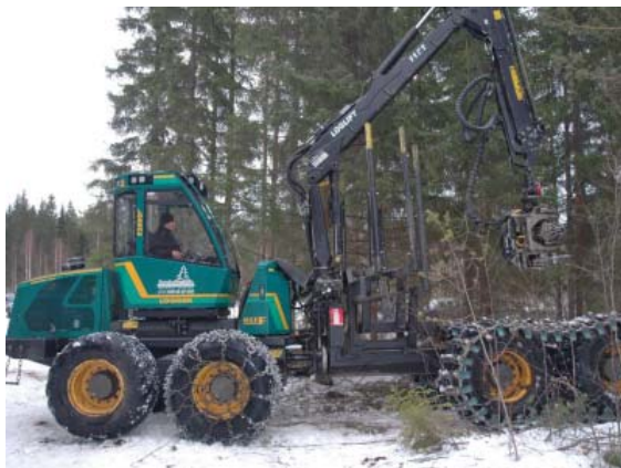
Рис. 20. Харвардер на базе форвардера. Предназначен для механизированной заготовки тонкомерной древесины при рубках ухода (Moisioforest)
