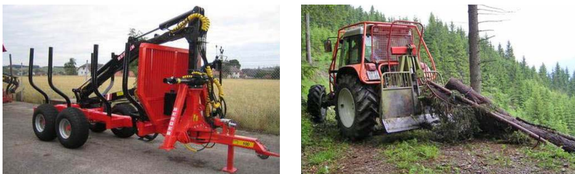
Рис. 4. Лесной прицеп к трактору и трактор с лебедкой/скиддер (LK Niederösterreich)
