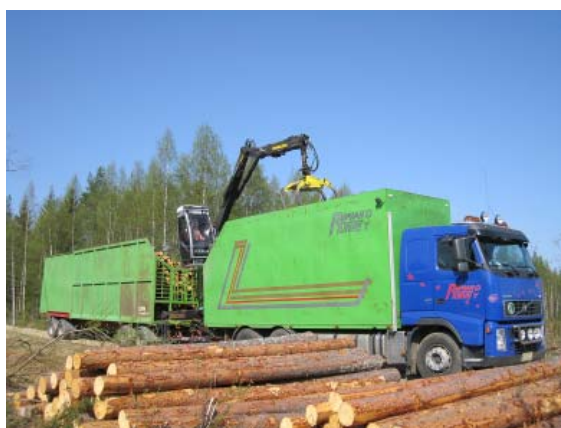
Рис. 26. Транспорт для перевозки биомассы с плотными бортами и дном (Juha Laitila)
