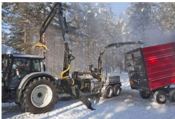
Рис. 14. Рубильная машина на базе с/х трактора, работающая на верхнем складе (Kesla)
