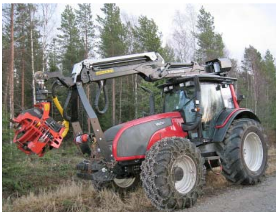
Рис. 22. Сельскохозяйственный трактор, оборудованный для лесных работ (Juha Laitila)
