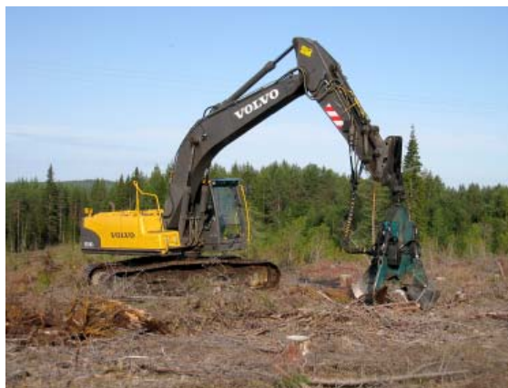
Рис. 18. Заготовка пней на сплошных вырубках одномодульным харвестером (Juha Laitila)
