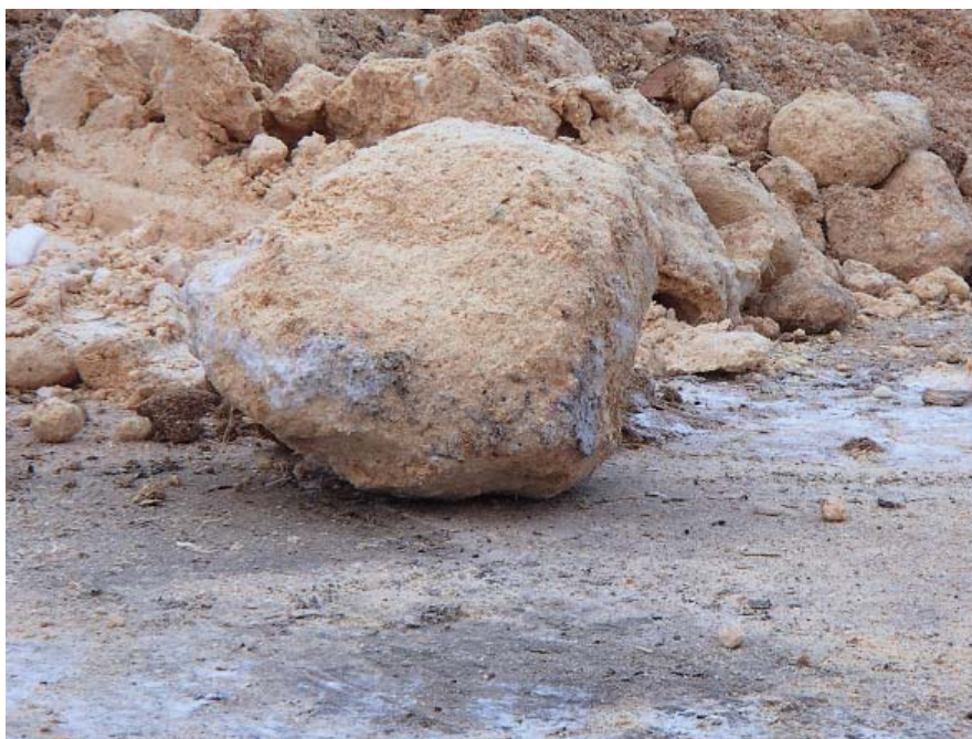
Рис. 30. Крупные куски льда могут вывести из строя транспортеры и котлы (Miina Jahkonen, 2013)
