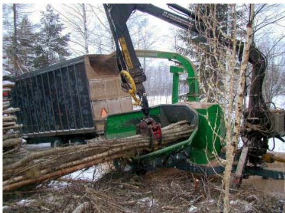
Рис. 67. Производство тонкомерной древесины в щепу с помощью дисковой рубительной машины (Kesla) у дороги (VTT)
