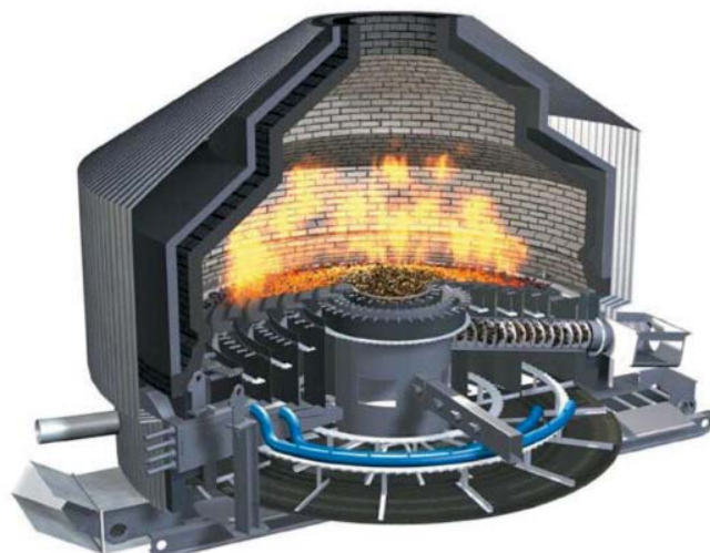
Рис. 42. Топка с колосниковой решеткой BioGrate для влажного топлива (Metso Power, между 4 и 20 МВт). Топливо подается шнеком снизу и на центр решетки. Топливо высыхает в центре решетки за счет тепла, отражаемого от кирпичей и за счет огня, не затрагивая топливный слой в зоне сжигания. От центра решетки топливо движется на периферию за счет фидеров. После почти полного сжигания остаточного углерода, зола падает с краев решетки в охлаждающую воду (Metso Power)
