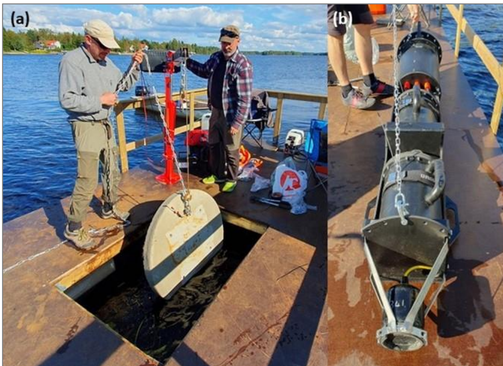
Kuva 2. (a) Betonipaino, johon kuhunkin ankkuroitiin yksi karkotin siirtymisen estämiseksi. (b) Otaq-mobiilikarkotin ennen asennusta lijoelle. Karkotintrunگون alaosassa, joka on myös kuvassa alimpana, näkyy lähetinyksikkö, runгон ylimmän osan kelluessa veden pinnalla. Keski-osassa näkyvät akut, jotka tässä kokeilussa olivat asennettuina ainoastaan verkkovirran katkoksien varalle. Valokuvat: Esa Lehtonen.
