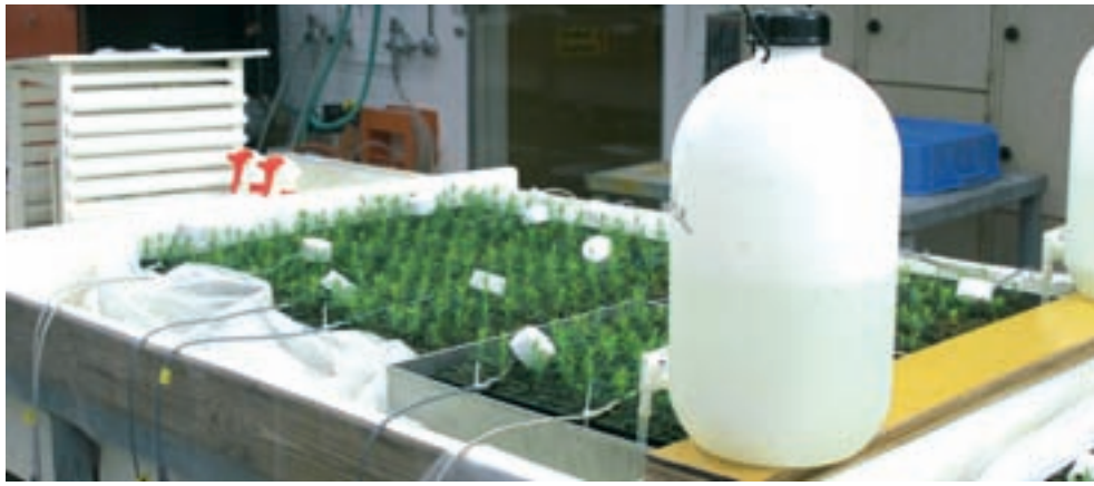
Kuva kastelukokeesta kasvihuoneessa. Valkoisten vesisäiliöiden avulla pidettiin jatkuvan altakastelun pohjavesitaso vakiona (lappomenetelmä). Valkoisten hattujen alla kasvuston sisässä tensiometrejä. Valokuva Pekka Voipio.
