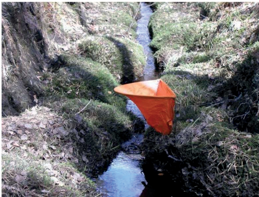
Kuva 9. Lannoitteiden levitystasaisuutta ja erityisesti rakeiden joutumista ojiin seurattiin Vuohensuolla tasaisuuden seurantaan kehitetyllä suppilomenetelmällä.
