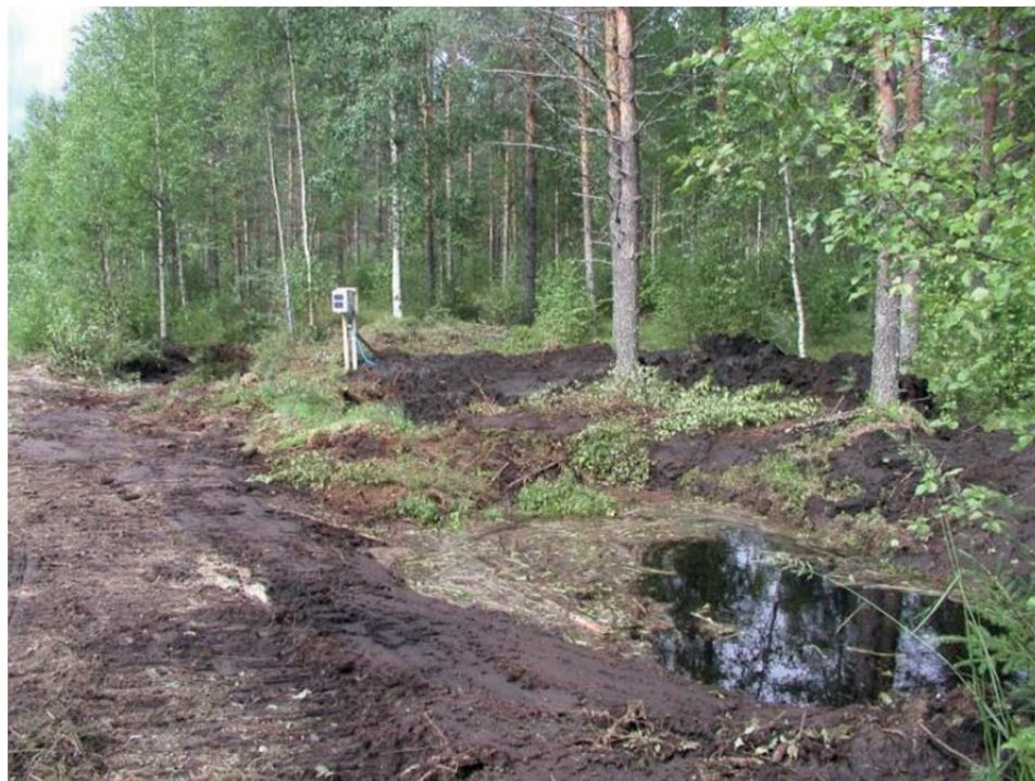
Kuva 10. Kuntalan kunnostusojitusalueen ultraääni-virtaamanmittauslaite asennettuna paikoilleen. Laitteisto koostuu molemmista päistään käyrästä rumpuputkesta, joka on upotettuna maan sisään. Mittauslaitteisto on kiinnitetty rumpuputken ulkopuolelle. Laitteistosta näkyy ulospäin vain kuvan keskellä näkyvä kotelo, joka sisältää virtalähteen, dataloggerin ja lähetinlaitteen.
