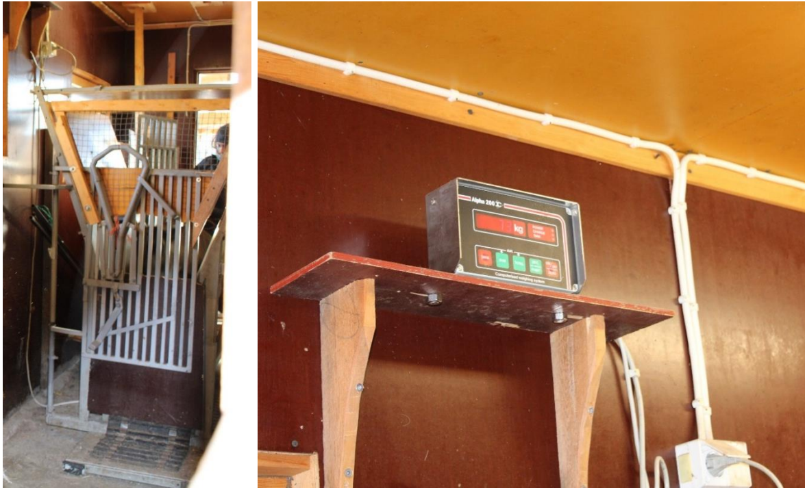
Kuva 22. Käsittelyhäkin alla on antureiden päällä levyvaaka ja punnitustulos on luettavissa digitaaliselta, häkin yläpuolella olevalta näytöltä. Kuvat: Luke/Katariina Manni.
