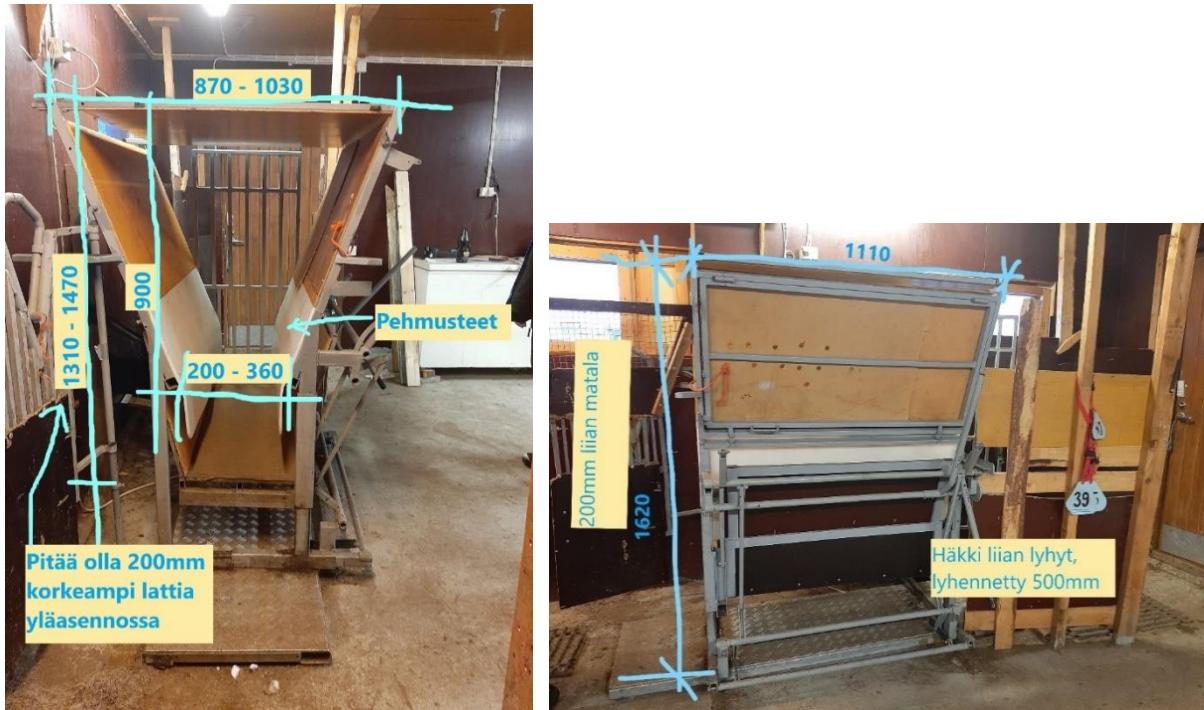
Kuva 24. Porojen tämänhetkinen käsittelyhäkki mittoineen. Kuvat: Luke/Jukka Siitari.
