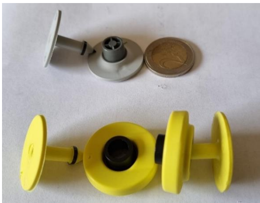
Kuva 31. Kuvassa alimpana on keltainen Allflexin elektroninen korvamerkki ja sen yläpuolella Kutuharjussa käytössä oleva perinteinen korvamerkki. Kuva: Paliskuntain yhdistys/Mika Tervonen.
