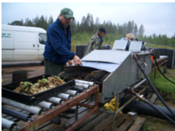
Kuva 3. Pohjan Taimen Ketolan taimitarhalla testattiin istutuslaatikoiden pesulinjaston soveltuvuutta pohjanruusujuuren juurakoiden pesuun. Kuva: Markku Koistinen
