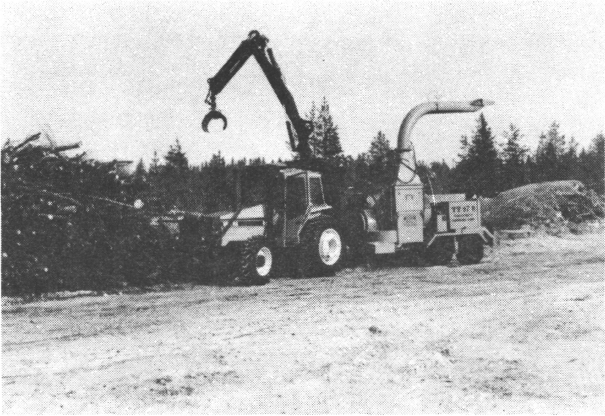
Kuva 2. TT 97 R -hakkuri, telipyöräalustainen perusmalli. Fig. 2. TT 97 R chipper, standard model on a trailer with a bogie.
