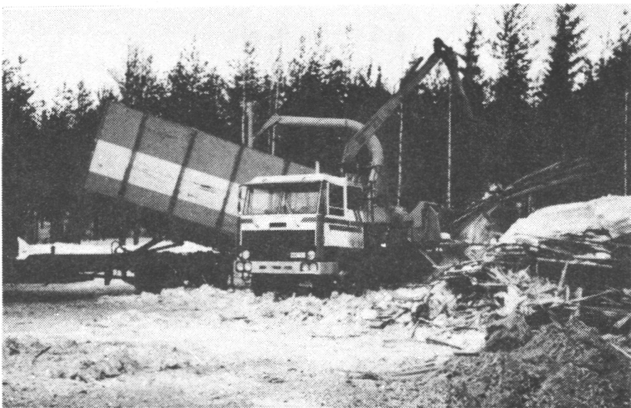
Kuva 3. TT 97 R -hakkuri, kuorma-autoalustainen versio. Fig. 3. TT 97 R chipper, truck mounted version.
