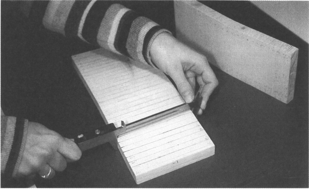
Kuva 2. Pituuden suuntaisen kutistuman määrittäminen. Kappale on sahattu ytimen kautta ja mitaus tehtiin 10 mm välein ytimestä pintaan. Kappaleen pituus mitattiin tuoreena heti sahauskeuhon jälkeen sekä uunikuivauksen jälkeen. Näytteet siis kuivattiin absoluuttisen kuivaksi ja näin saatiin selville suurin mahdollinen kutistuma. Samanaikaisesti mitattiin myös kappaleen leveys em. kohdista ja näin saatiin selville tangentin suuntainen eli lustojen myötäinen kutistuma ytimestä pintaan. Vastaavanlaiset kappaleet sahattiin myös oksakiehkuran kohdalta niin, että oksa oli toisessa syrjässä. Näin saatiin selville oksan vaikutus pituuskuutistumaan.
